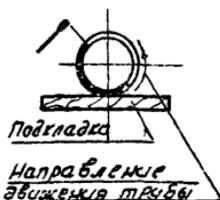
Схема наложения слоев шва поворотного стыка.
