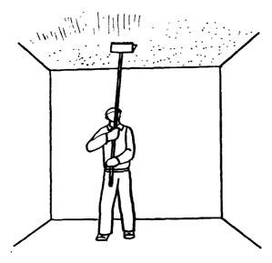
Штукатуры Ш<sub>6</sub> и Ш<sub>7</sub> работают само— стоятельно. Штукатур встает спиной к торцевой стене и лезвием шпателя при движении его "на себя" разравнивает накрывочный слой и снимает излишки раствора ("на сдир"). Каждая следующая разравниваемая полоса должна перекрывать предыдущую на 3 см. Излишки раствора штукатуры сбрасывают в ящик
