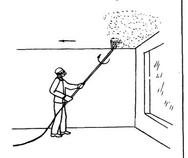
работку потолка проводят до появления матовой поверхности). Штукатур Ш<sub>5</sub> приступает к работе, находясь у поперечной стены комнаты в 80-100 см от продольной. Во время работы он двигается параллельно поперечной стене, отступая назад на 80-100 см для обработки каждого следующего участка потолка. Дойдя до угла комнаты он отступает вбок и начинает двигаться в обратном направлении. Так он обрабатывает весь потолок, причем каждая следующая полоса должна перекрывать предыдущую на 3-5 см
