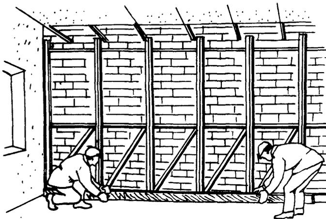
Держа пакет плит за оба конца горизонтально, столяры С<sub>1</sub> и С<sub>2</sub> переносят их в помещение и прислоняют к стене. Плиты подносят в количестве несколько большем, чем требуется на одну захватку. Затем столяры ножами разрезают упаковочную
