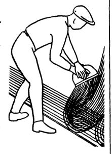
2 СПЛОШНАЯ ШЛИФОВКА СТЕН; 78 мин; М<sub>1</sub>, М<sub>2</sub>; пневматические затирочные машины, компрессоры, столик-подмости
