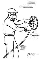
маляр поворачивается боком к стене и работает в полусогнутом положении. Обработку нижней части участка он выполняет согнувшись. Держа машину в
