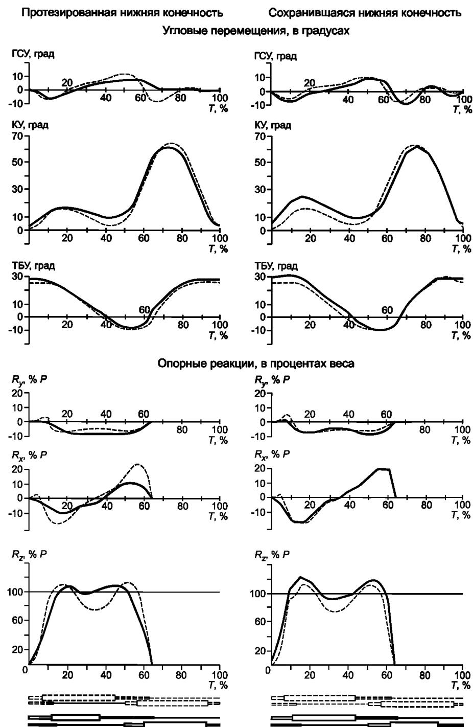
$T, \%$  — время двойного шага, в процентах;  $R_x$  — продольная составляющая опорной реакции;  $R_y$  — поперечная составляющая опорной реакции;  $R_z$  — вертикальная составляющая опорной реакции.
