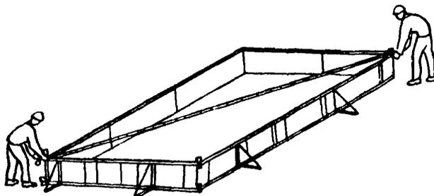
Слесари С<sub>1</sub> и С<sub>2</sub>, стоя у противоположных углов короба опалубки, проверяют при помощи рулетки соответствие размеров диагоналей короба проекту
