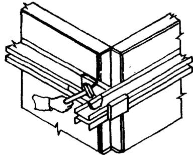
Каждый из слесарей, работая самостоятельно, вставляет болт в совмещенные отверстия в щите и монтажном уголке и навинчивает на болт гайку. Затем вставляет чеку в паз между швеллерами пояса фермы (верхнего и нижнего), вставляет клин в овальные отверстия двух швеллеров и чеки и кувалдой или молотком забивает его
