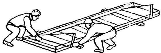
2 УСТАНОВКА МОНТАЖНЫХ УГОЛКОВ; 8 мин; C<sub>1</sub>, C<sub>2</sub>; гаечные ключи
