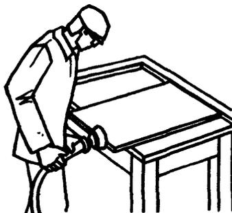
При неплотном прилегании плит облицовщи- ки О<sub>1</sub> и О<sub>2</sub> дополнительно шлифуют кромки отдельных плит шлифовальными машинами, а затем укладывают плиты на место и про- веряют плотность их примыкания по всей площади помещения
