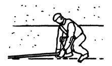
Бетонщи**ии**  $\mathbf{B}_1$  и  $\mathbf{B}_2$  берут конщы реек, утопленных в растворе и поднимают их вверх, после чего относят к новому месту укладки
