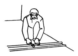
Облицовщики оттибают кромки полотнищ, кистью наносят на основание клей, а затем плотно прижимают кромки к намазанному основанию
