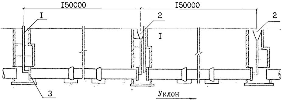
Заглушки для испытания трубопроводов
