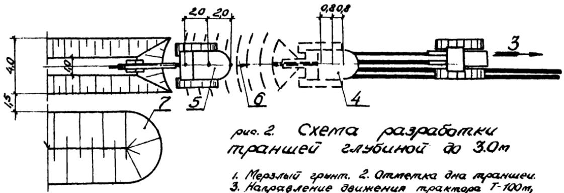
рис. 2. Схема разработки траншеи глубиной до 3.0м
