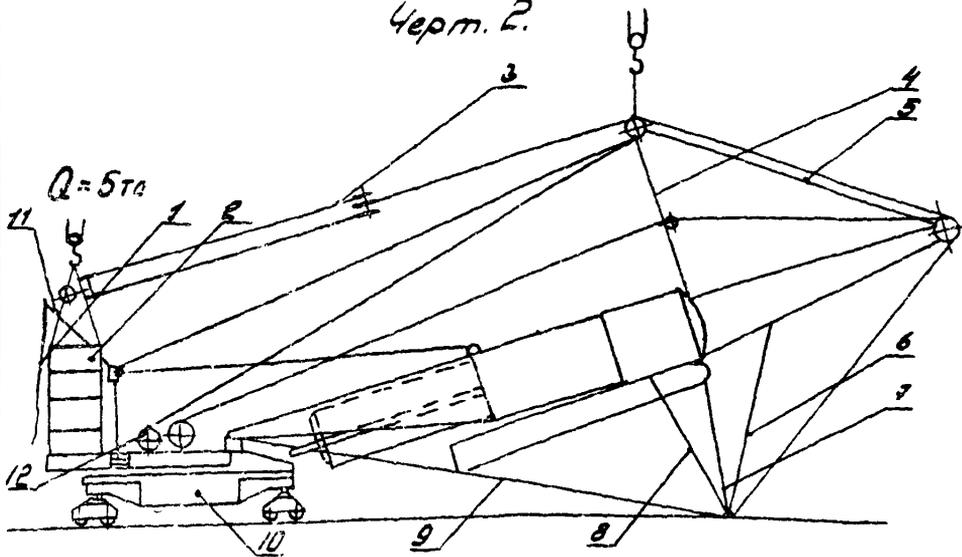
1-затяжка; 2-противовес; 3-стреловая полумаст; 4-распорка башни; 5-оттяжка; 6-оттяжка стойки; 7-монтажная стойка стрелы; 8-оттяжка стойки; 9-стреловая расчалка; 10-балка; 11-монтажная стойка; 12-стреловая лебедка.
