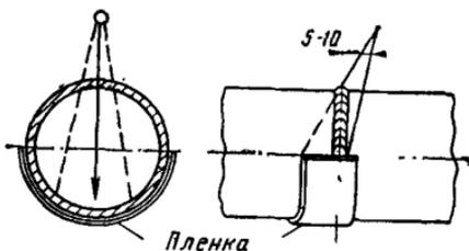
Рис. 10. Просвечивание сварных стыков труб малого диаметра через две стенки за одну установку источника излучения
