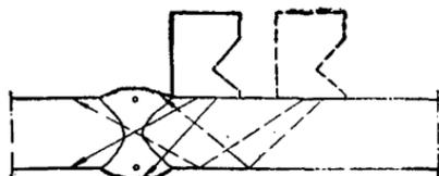
Рис. 13. Контроль стыковых швов металла толщиной свыше 20 мм
