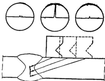
Рис. 17. Определение высоты дефекта
