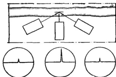
Рис. 15. Выявление трещины или непровара
