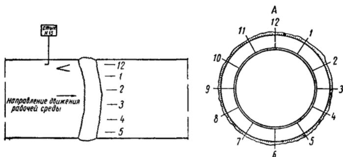
Рис. 22. Контролируемый стык, разбитый на 12 частей
