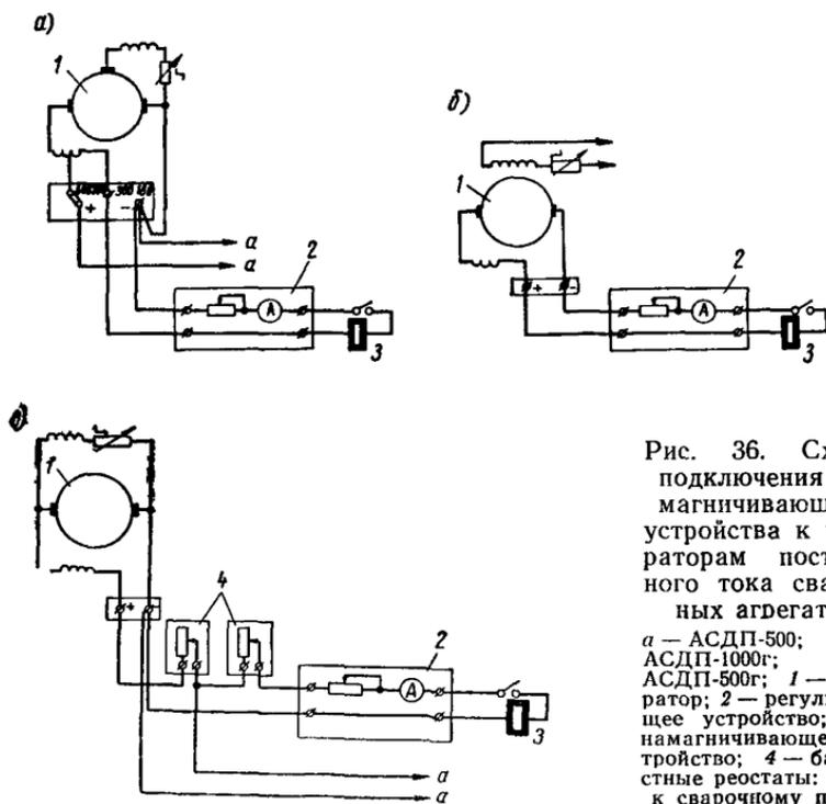
Рис. 36. Схемы подключения намагничивающего устройства к генераторам постоянного тока сварочных агрегатов
