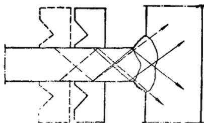
Рис. 18. Прозвучивание углового шва
