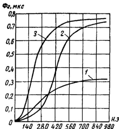
Рис. 33. Амплитудные характеристики магнитных лент по остаточному потоку
