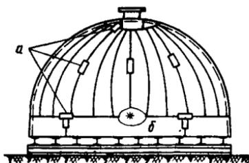
Рис. 7. Просвечивание сферического купола кожуха воздушонагревателя и аналогичных конструкций
