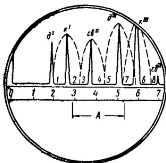
Рис. 19. Расположение сигналов на экране дефектоскопа при правильной настройке скорости развертки *A* — область появления сигналов от дефекта;  $\delta^I$ ,  $\delta^{III}$  — сигналы от дефекта;  $\kappa^I$ ,  $\kappa^{III}$  — сигналы от подкладного кольца;  $cd^{II}$ ,  $cd^{IV}$  — сигналы от сверления под усиления шва; 1–8 — точки, ограничивающие точку появления и исчезновения сигналов
