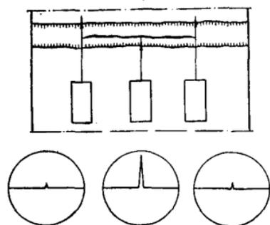
Рис. 14. Определение протяженности дефекта
