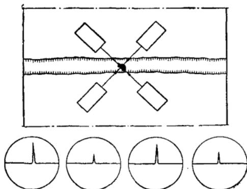
Рис. 16. Выявление пор или шлаковых включений
