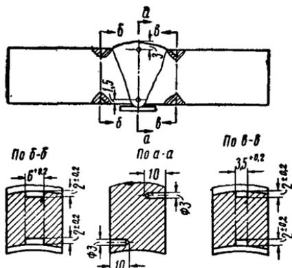
Рис. 31. Эталонный образец для настройки дефектоскопа
