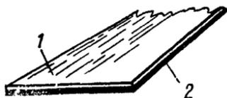
Рис. 32. Конструкция двухслойной магнитной ленты
