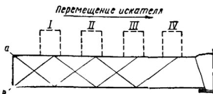
Рис. 20. Настройка скорости развертки по углам эталонного образца
