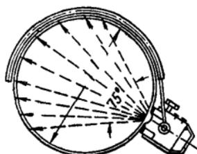
Рис. 9. Просвечивание сварного стыка трубы через две стенки
