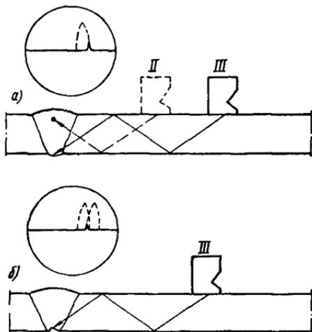
Рис. 25. Контроль сварного стыка, сваренного на удаляемом подкладном кольце
