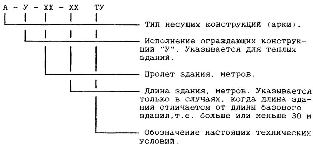
Пример условного обозначения при заказе комплекта конструкций на здание арочного типа, утепленного, пролетом 12 м., длиной 45 м.:
