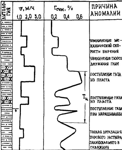
Газовые аномалии могут быть связаны с поступлением в буровой раствор газа, обусловленного добавками нефтепродуктов и щелочных химреагентов. Добавки в буровой раствор нефтепродуктов (особенно недегазированной нефти) значительно повышают общий газовый фон и часто ведут к полной потере полезной информации. Распознавание причины аномалии обыч-
