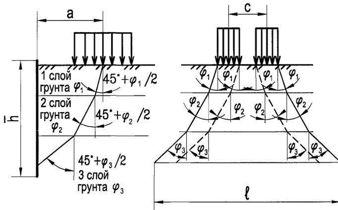
Рисунок 10.5 — К определению эквивалентной нагрузки при наличии за стенкой нескольких слоев грунта, отличающихся углами внутреннего трения
