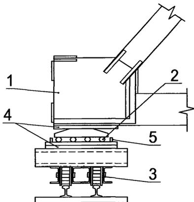
Рисунок 28.6 — Опирае узла пролетного строения при поперечной перекалке на тележках
