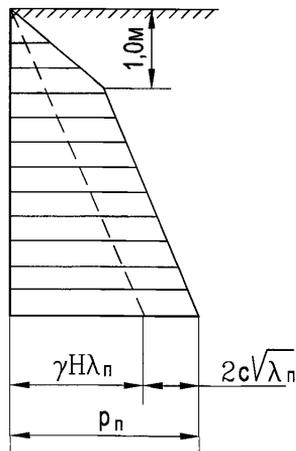
Рисунок 10.11 — Эпюра пассивного давления суглинка или глины на стенку ограждения
