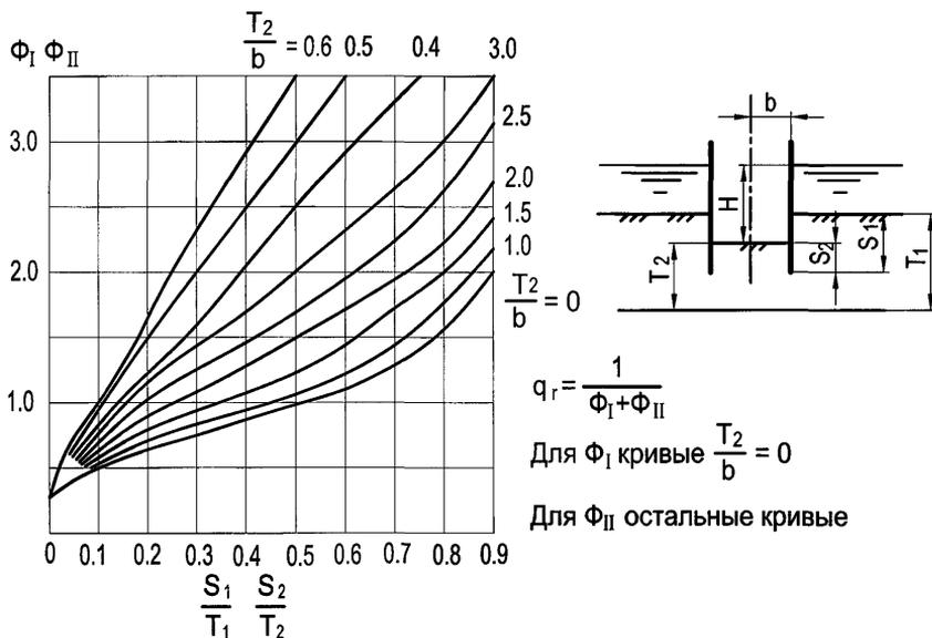
Рисунок 2 — График для определения  $q_r = f(S_1 : T_1 ; S_2 : T_2)$
