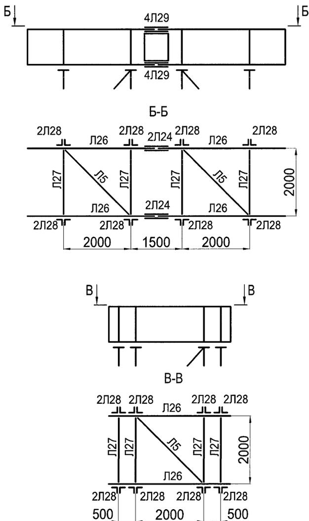
Рисунок 5.2 — Схемы компоновки сборных ростверков МИК-С2
