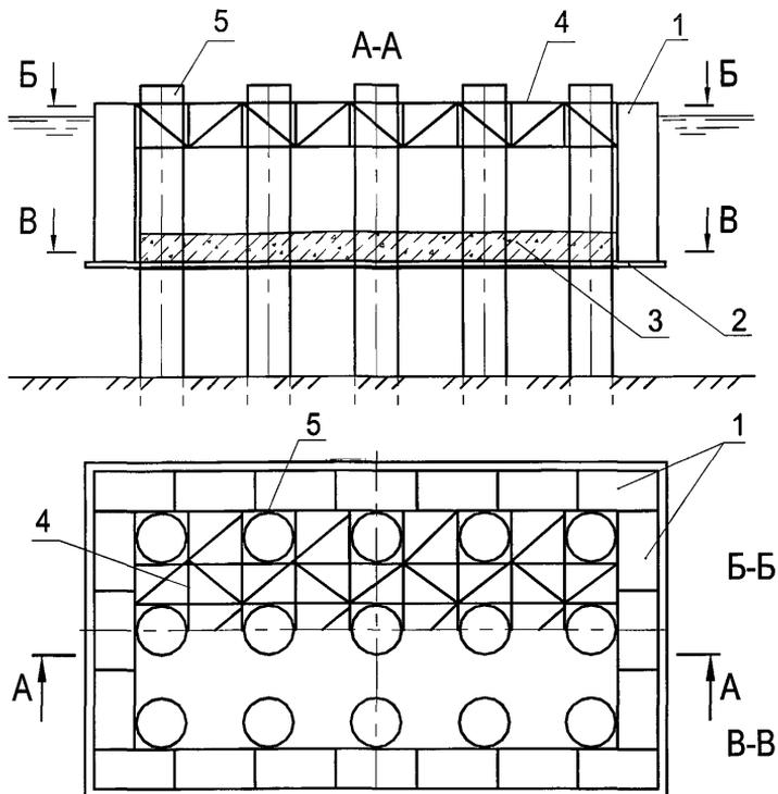
Рисунок 21.3 – Перемычка из понтонов
