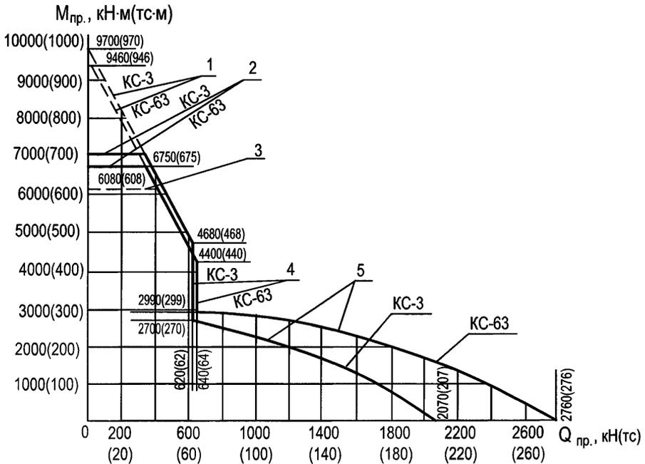
Рисунок 7.3 — График предельных усилий на понтоны КС-3 и КС-63 при изгибе в плоскости палубы.
