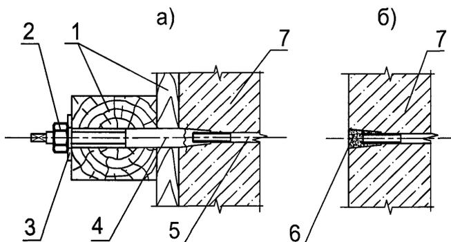
Рисунок 38.1— Тяжи со съёмными наконечниками
