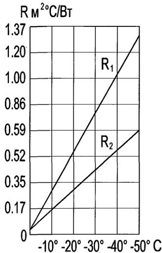
Рисунок 38.4 — Кривые зависимости оптимального термического сопротивления боковых поверхностей опоры  $R$  (в  $\text{м}^2 \cdot \text{°C}/\text{Вт}$ ) от расчетной температуры наружного воздуха,  $\text{°C}$  ( $R_1$  - для торцовых поверхностей и боковых частей поверхности, прилегающих на 2 м к углам опоры;  $R_2$  - для остальных частей боковых поверхностей).
