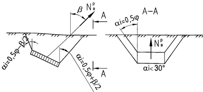
Рисунок 35.2 — Расчетная схема закопанного закладного якоря
