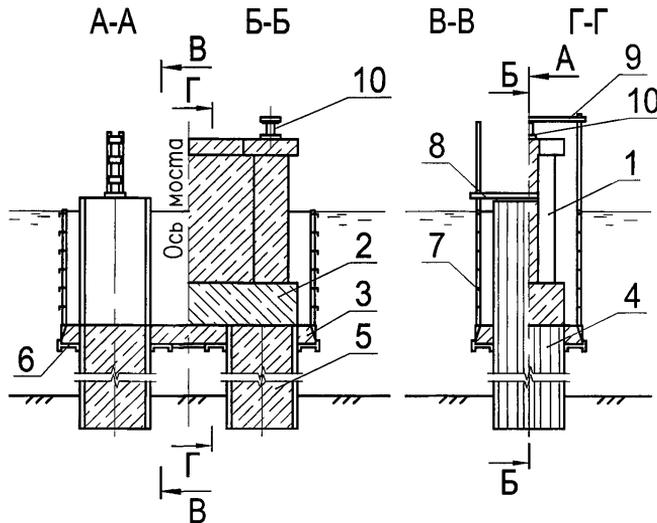
Рисунок 21.2 – Металлическое щитовое ограждение ростерка
