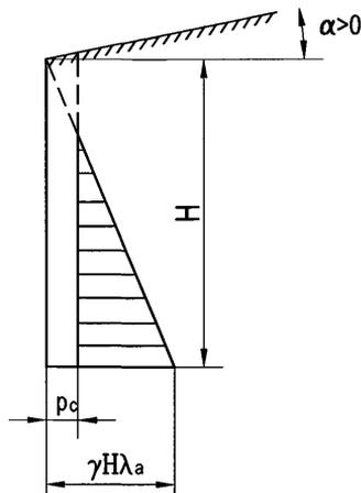
Рисунок 10.9 — К определению активного давления суглинка или глины
