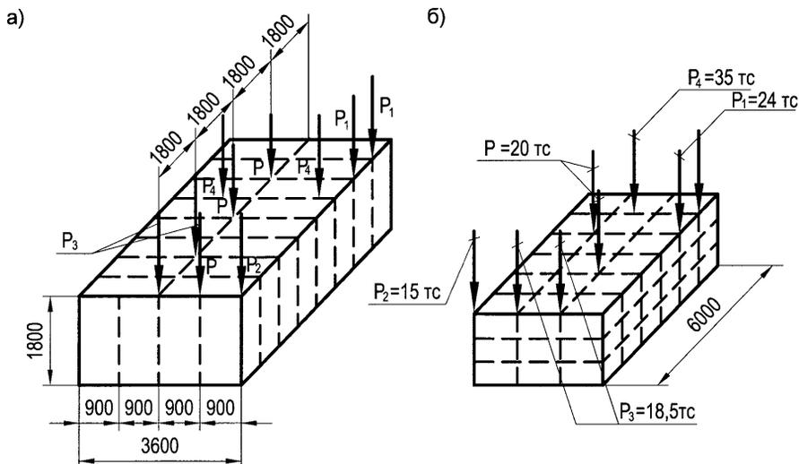
Рисунок 7.1 — Схема нагрузок на узлы понтонов
