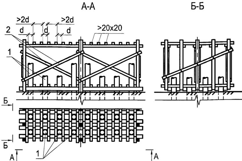
Рисунок 22.1 – Направляющий каркас из деревянных элементов
