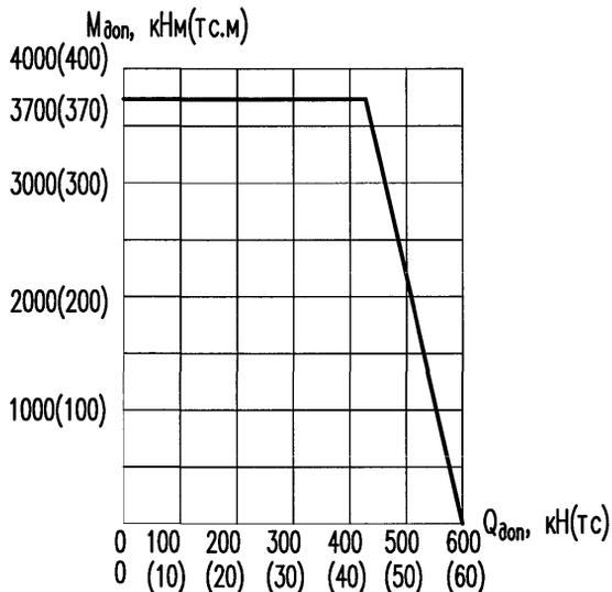
Рисунок 7.4 — График допустимых усилий на понтон УП-78
