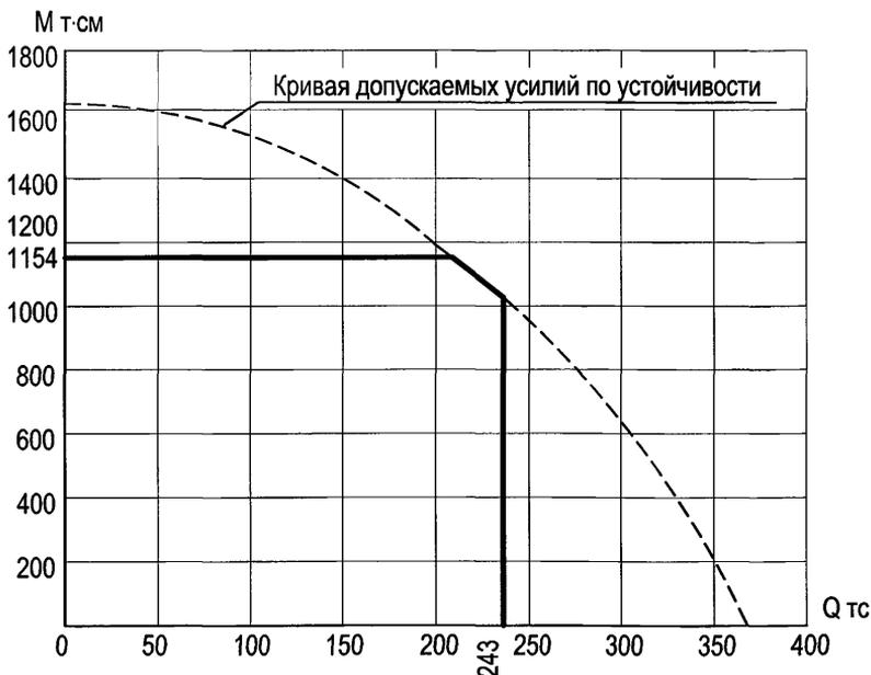
**Рисунок 7.7 — График допустимых усилий на понтон КС-63М при изгибе в плоскости бортов**
