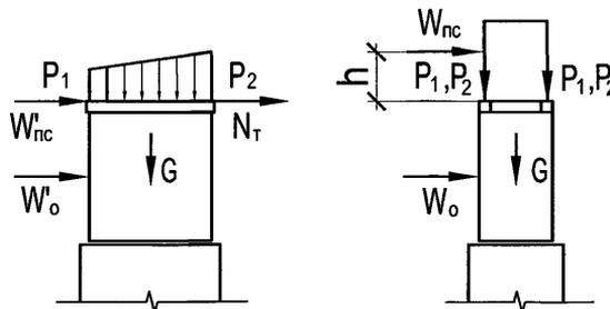
Рисунок 26.1 – Схема приложения нагрузок к перекаточной опоре.
