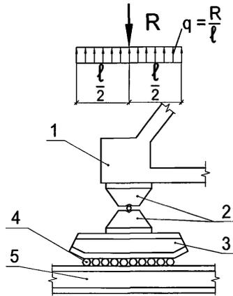
Рисунок 28.5 — Балансирное опирание узла пролетного строения на накаточные пути при продольной навдвижке на плаву
