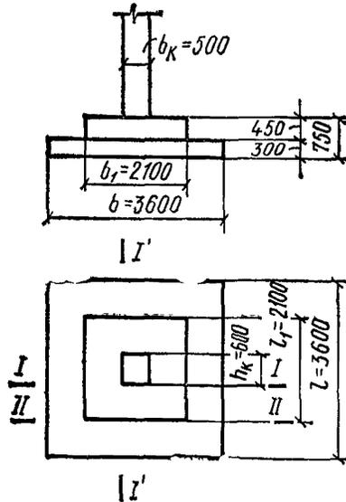
Рис. 41 Центрально нагруженный фундамент
