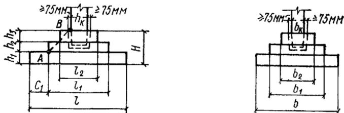
Рис. 15. Минимальные размеры ступеней при трехступенчатом фундаменте
