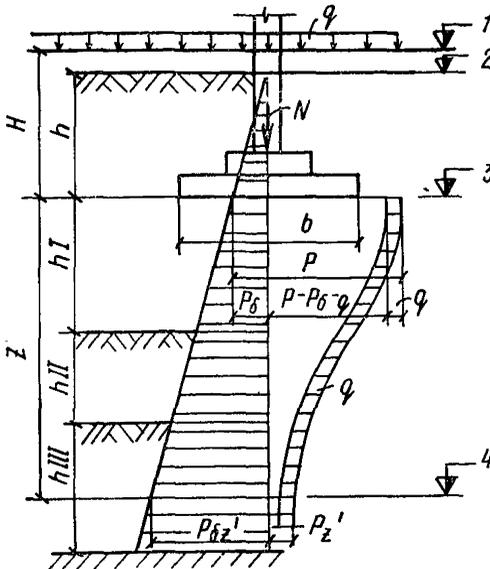
Рис 6 Расчетная схема распределения давления на горизонтальных сечениях в грунте ниже подошвы фундамента при действии сплошной равномерно распределенной нагрузки
