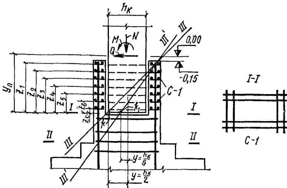
Рис 23 Расчетная схема стаканной части подколонника
