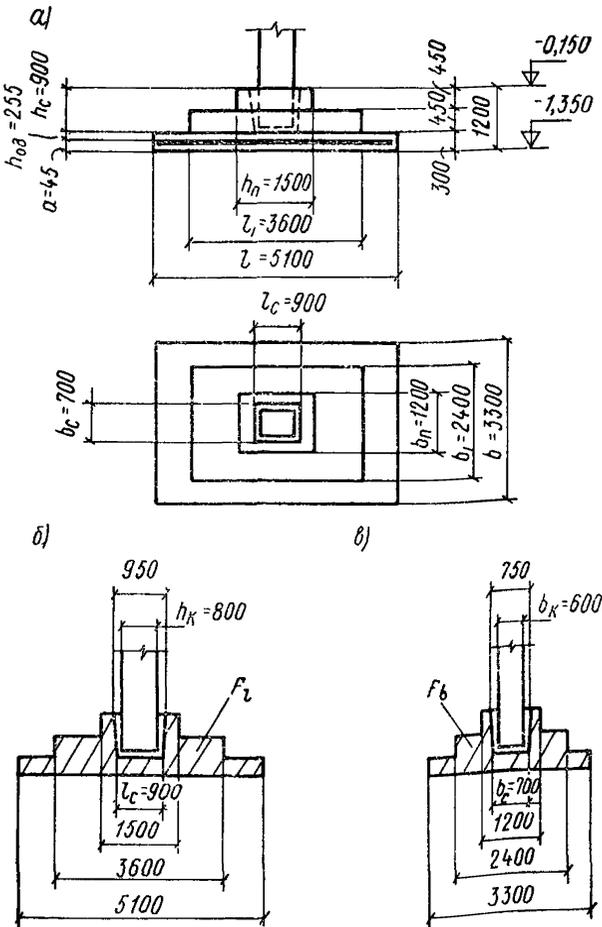
Рис 43 Внецентренно нагруженный стаканый фундамент
