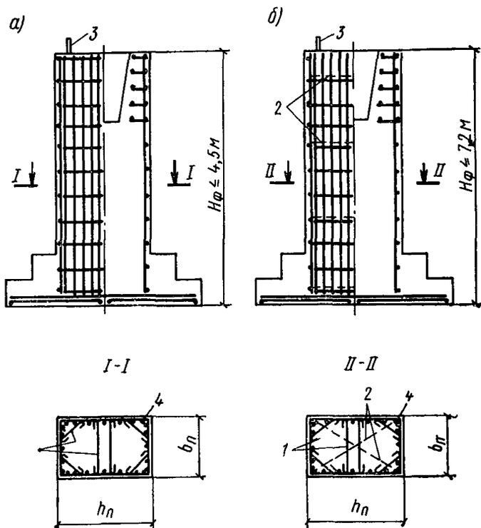
Рис 31. Армирование фундамента колонн пространственными самонесущими арматурными каркасами, собираемыми из плоских сеток
