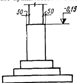
Рис. 28 Фундамент под монолитную колонну
