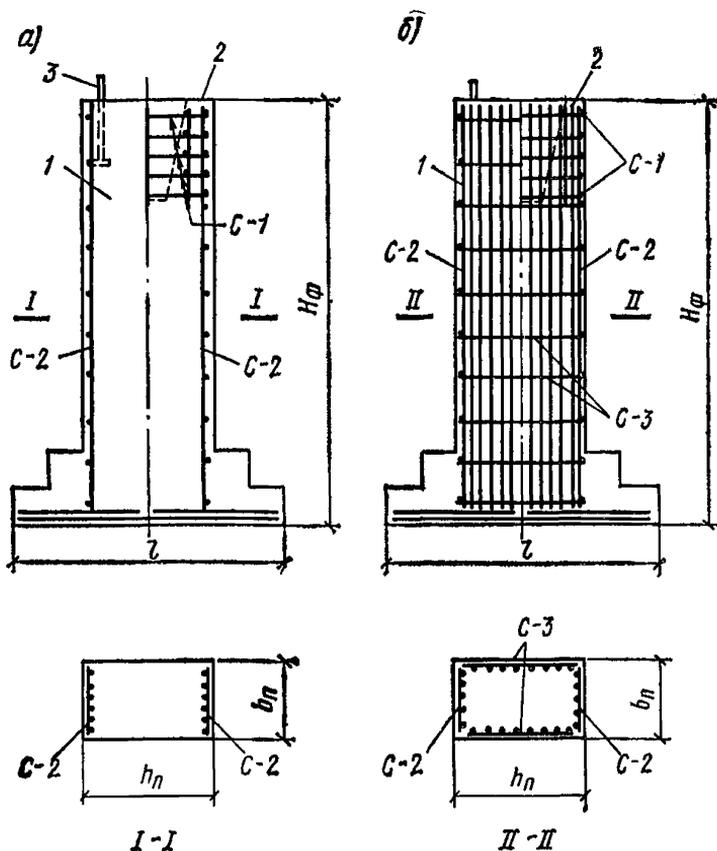
Рис 22 Армирование фундаментов колонн сварными сетками с навеской их на опалубку
