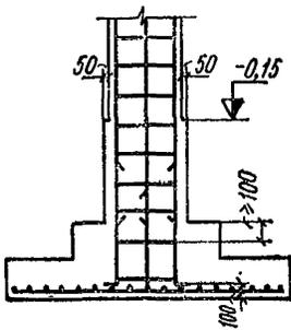
Рис 32 Соединение монолитных фундаментов с монолитными колонами при армировании отдельными стержнями
