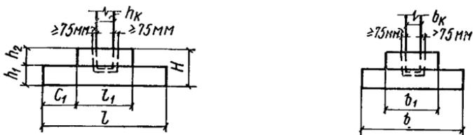
Рис. 14. Минимальные размеры ступеней при двухступенчатом фундаменте
