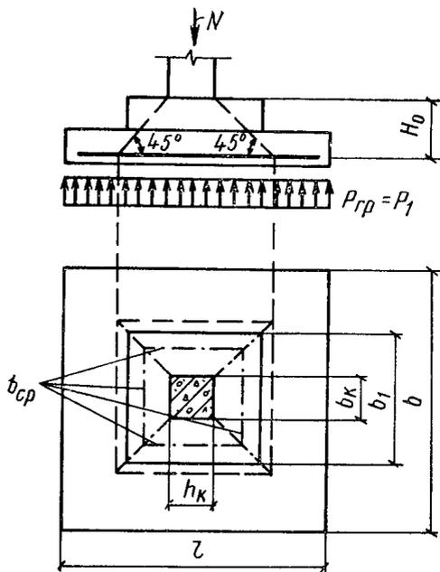
Рис. 8. Схема образования пирамиды продавливания в центрально нагруженных прямоугольных, а также внецентренно нагруженных квадратных и прямоугольных фундаментах
