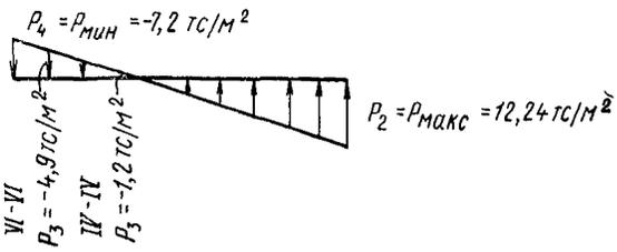
Рис 52 Размеры фундамента и расчетная схема при расчете фундамента на «обратный момент»
