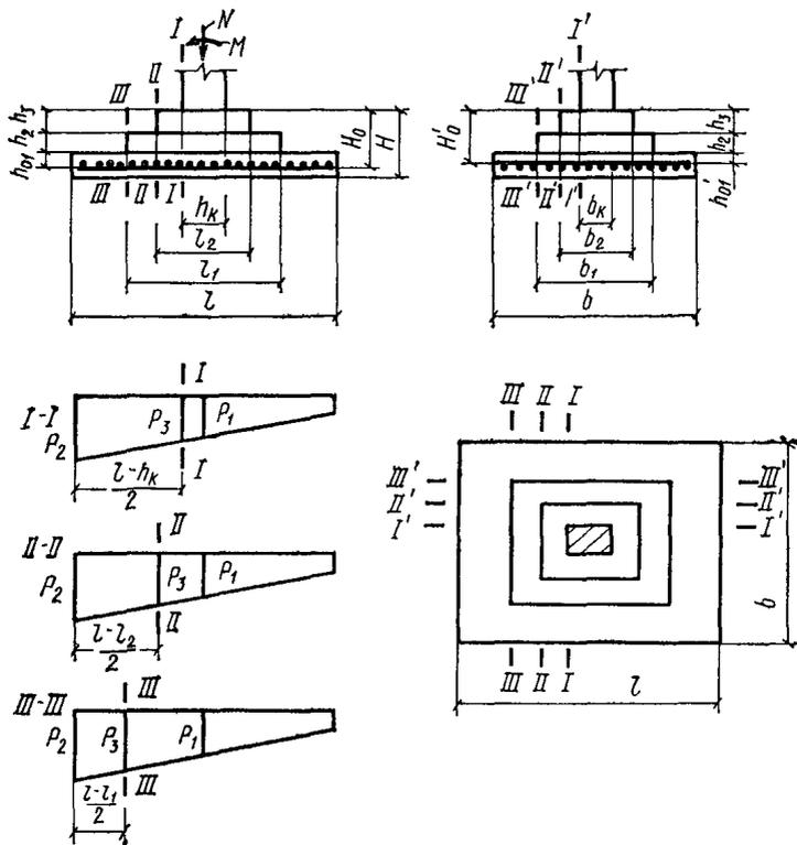
Рис. Расчетные схемы для определения арматуры подошвы фундамента
