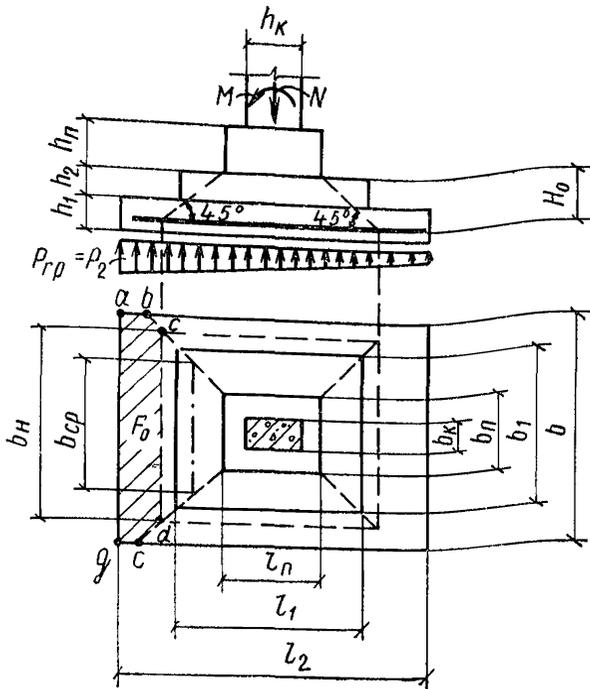
Рис. 10. Схема образования пирамиды продавливания в центрально нагруженных прямоугольных, а также **внецентренно нагруженных квадратных и прямоугольных фундаментах при высоте подколоники**
