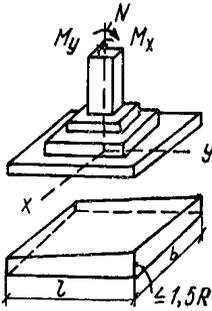
Рис 3 Эпюры давления на грунт внецентренно нагруженного фундамента с моментами в двух направлениях
