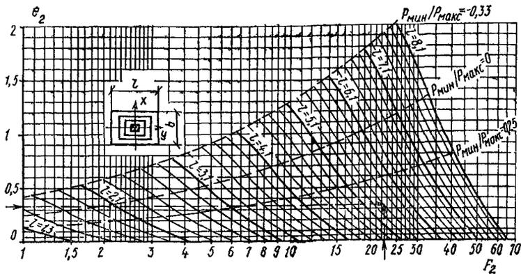
Рис 58. График для определения размеров подошвы фундаментов  $F_2 = \frac{N+G}{1,2 R m}$ ;  $e_2 = \frac{M}{N+G}$  — для внецентренно нагруженного
