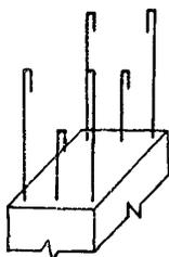
Рис. 34. Расположение стыков вязанных каркасов при трех выпусках арматуры класса А-I
