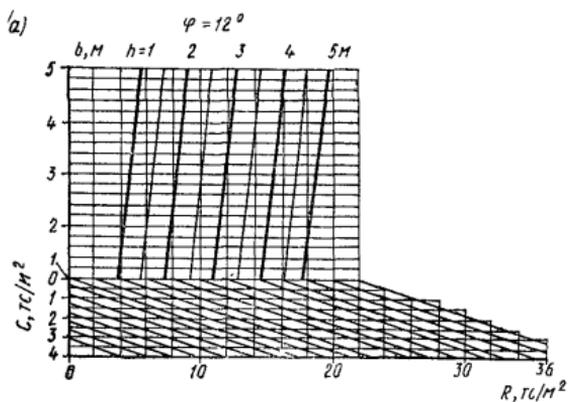
Рис 56. Графики для определения расчетного давления на основании
