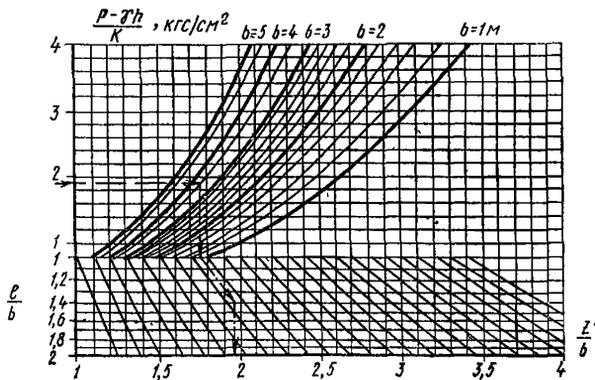
Рис 59 График для определения глубины  $z'$  сжимаемой толщи основания. Порядок определения отношения  $\frac{z'}{b}$  указан на графике
