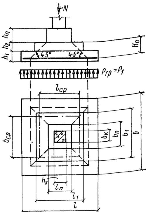
Рис. 9. Схема образования пирамиды продавливания в центрально нагруженных квадратных железобетонных фундаментах при высоте
