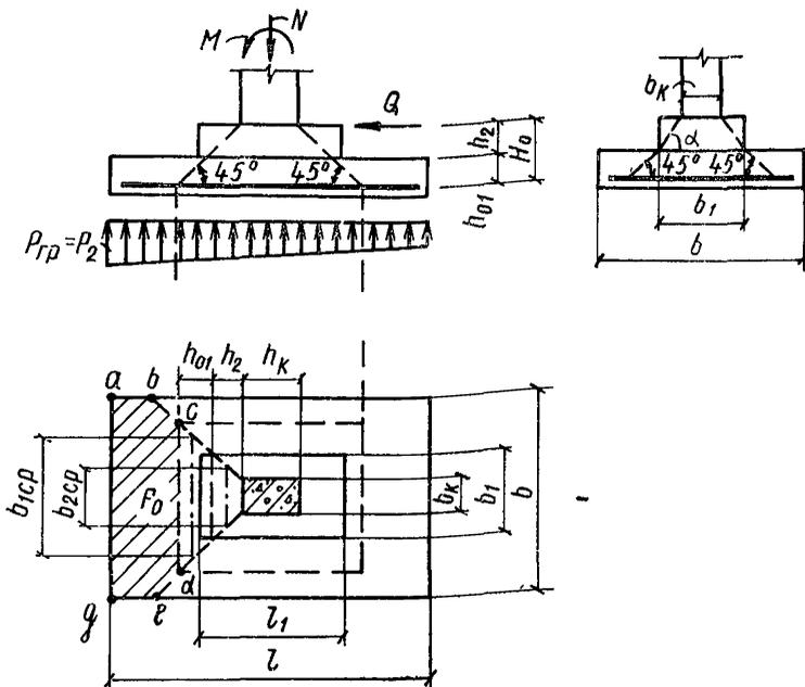
Рис 11 Схема образования пирамиды продавливания в прямоугольных железобетонных фундаментах с верхней ступенью с размерами, при которых одна из сторон ступени  $l_1 > h_{кр} + 2h_2$ , а другая  $b_1 < b_{кр} + 2h_2$
