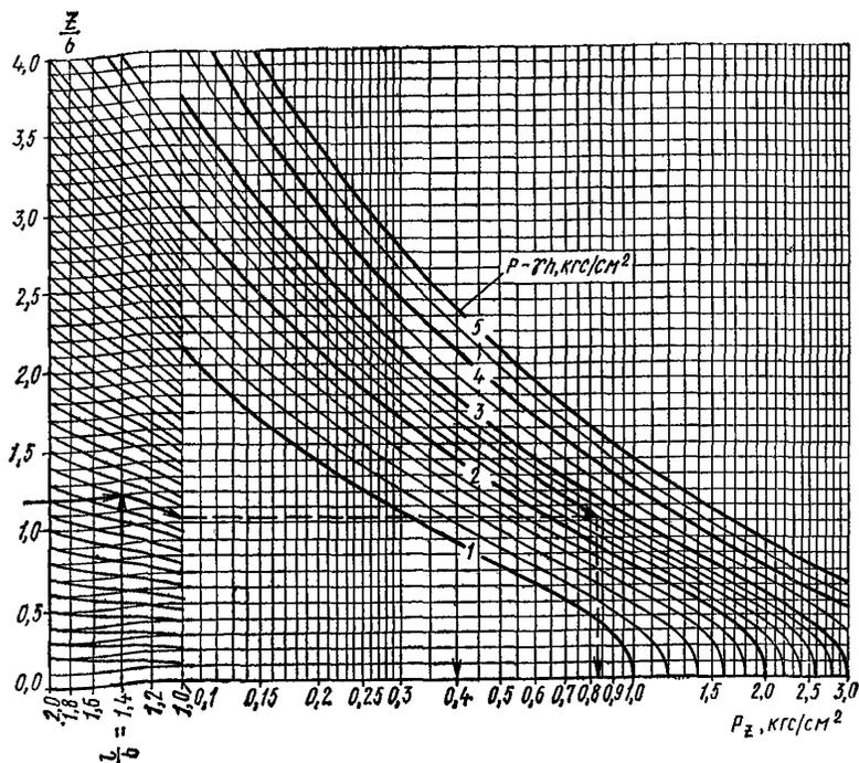
Рис. 60. График для определения дополнительного (к природному) давления в грунте  $p_z$  (на глубине  $z$  ниже подошвы фундамента). Порядок определения  $p_z$  указан на графике стрелками. В частности, для  $z/b=1,2$ ,  $l/b=1,4$ ;  $p - \gamma h=2,6$  кгс/см<sup>2</sup> находим  $p_z=0,83$  кгс/см<sup>2</sup>
