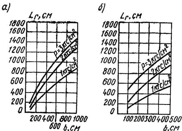
Рис. 46. Графики для определения расстояния между осями фундаментов, при котором учитывается взаимное влияние осадок
