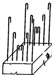
Рис. 36. Расположение стыков вязанных каркасов при шести выпусках арматуры А-I
