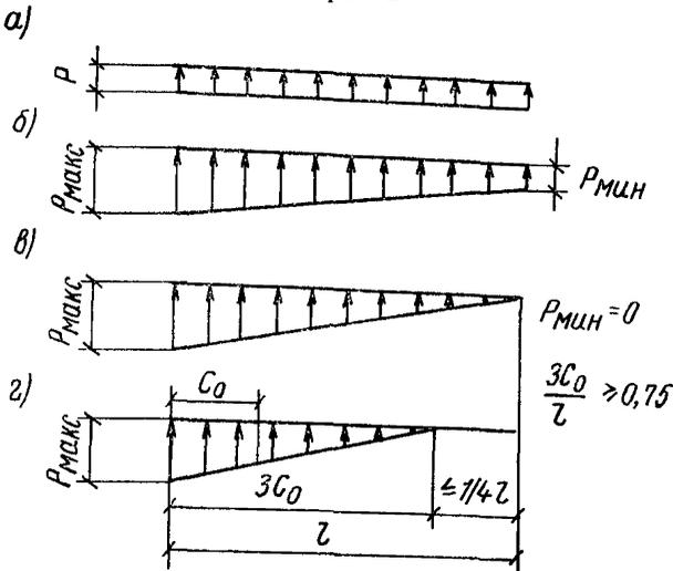
Рис 2 Эпюры давления на грунт
