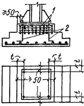
Расстояние  $t$  от оси анкерного болта подколонника должно быть не менее  $4d$  и не менее 150 мм при диаметре анкерных болтов до 48 мм и не менее 200 мм при диаметре анкерных болтов более 48 мм (рис. 40). Для болтов с анкерной плитой расстояние от грани анкерной плиты до грани подколонника должно быть не менее 70 мм.
