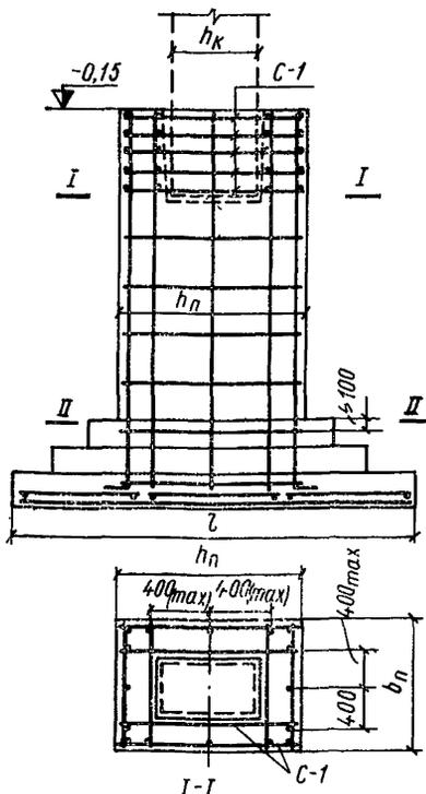
Рис 21. Армирование подколонника и его стаканной части
