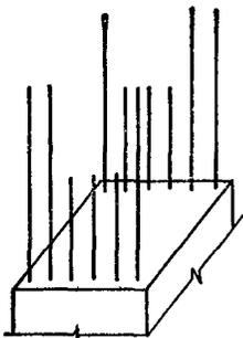
Рис. 33. Расположение стыков вязанных каркасов при арматуре периодического профиля
