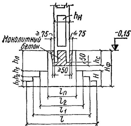
Рис. 26. Фундамент ступенчатого типа с подколонником под сборную двухветвевую колонну
