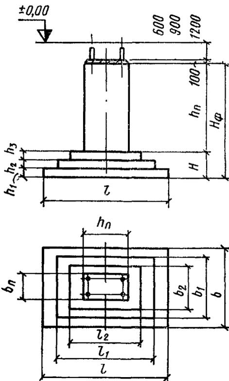
Рис 38 Фундаменты под стальную колонну
