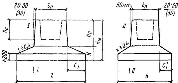
Рис 37 Сборные фундаменты (размеры в числителе при металлической опалубке, в знаменателе — при деревянной)
