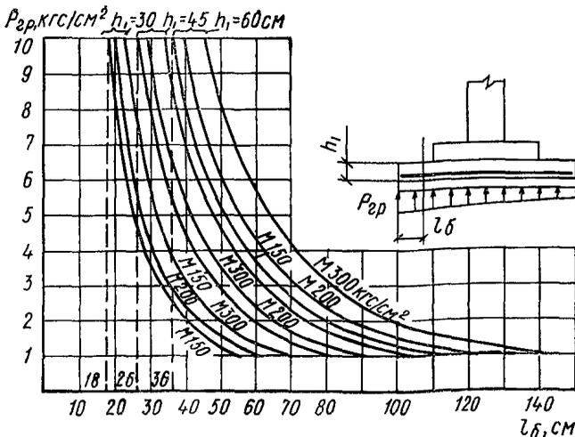
Рис 63 Предельные значения длины участка  $l_{\delta}$  нижней ступени фундамента (высотой  $h_1=30, 45, 60$  см из бетона марок М150, М200, М300  $\text{кгс/см}^2$ ), на которой прочность наклонных сечений обеспечивается бетоном
