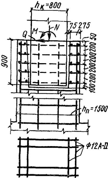
Рис 48. Армирование стаканной части подколонника
