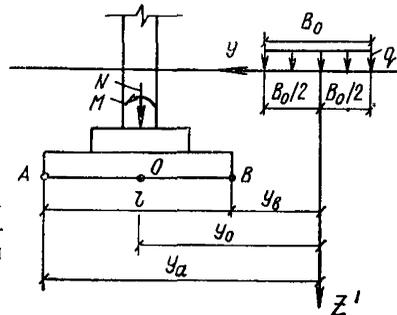
Рис 5 Расчетная схема фундамента при действии местной равномерно распределенной нагрузки в виде полосы
