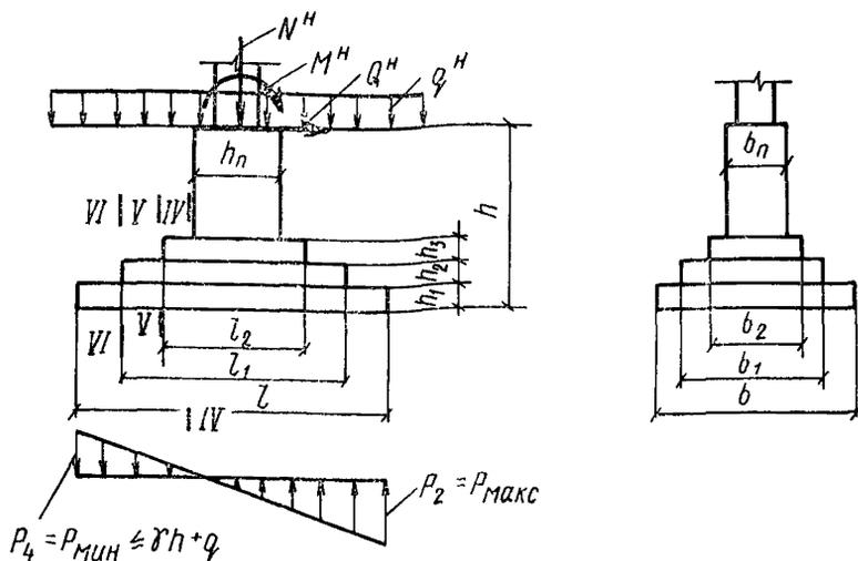
Рис 51 Расчетная схема фундамента при расчете фундамента на «обратный момент»
