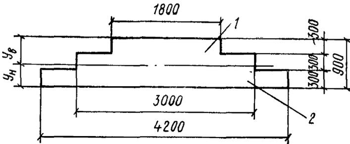
Рис. 53. Плитная часть фундамента в сечении IV—IV
