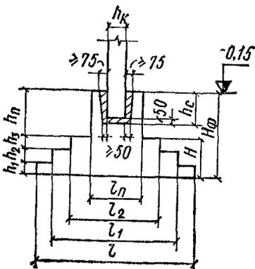
Рис. 25. Фундамент ступенчатого типа с подколонником под сборную прямоугольную колонну
