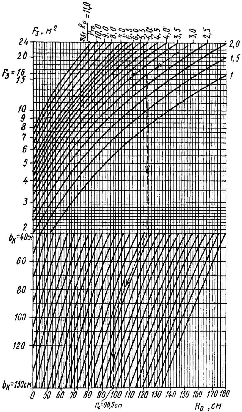
Рис. 61. График для определения рабочей высоты фундамента  $H_0$ . Для центрально нагруженного фундамента  $p_{гр} = p_1 = \frac{N}{lb}$ , кгс/см<sup>2</sup>; для вне-
