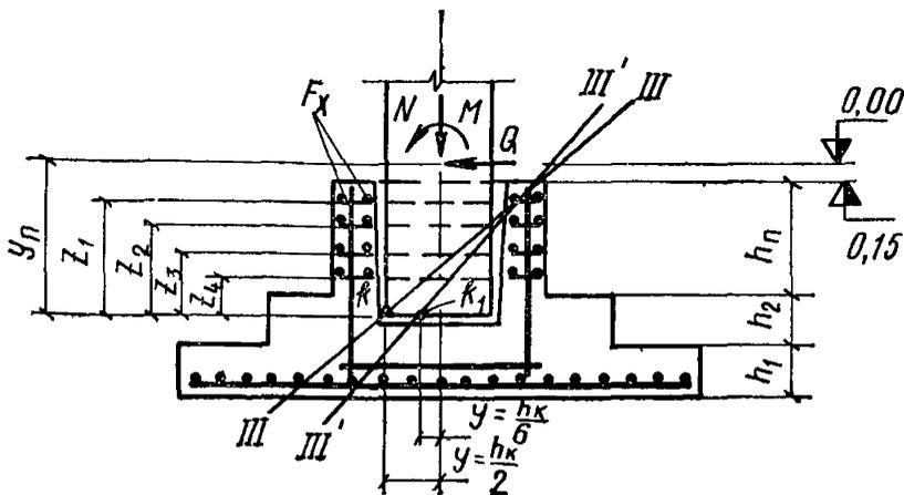
Рис. 24 Расчетная схема стаканной части подколонника при заглублении стакана в плитную часть фундамента
