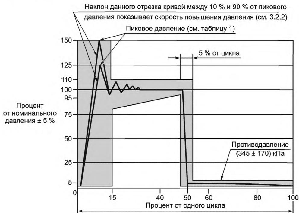
Рисунок — Кривая импульса
