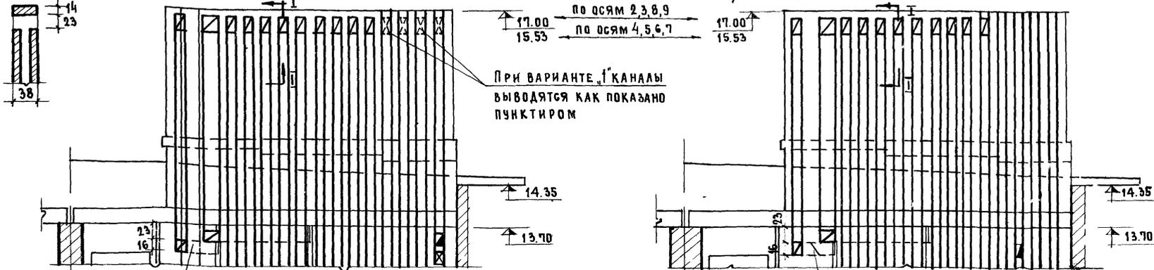
ПОСЛЕ МОНТАЖА КАНАЛИЗАЦИОННОГО СТОЯКА С  $\nabla 12.50$  НИШУ ЗАЛОЖИТЬ КИРПИЧОМ
