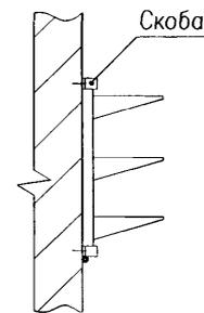
1. Проводник присоединяют в начале и конце трассы к устройству заземления.
