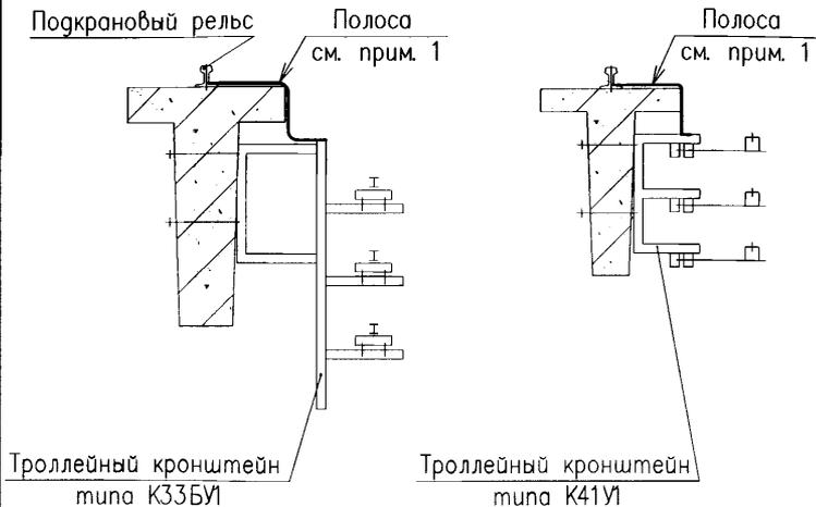
1. Каждый троллейный кронштейн с помощью перемычки присоединяют сваркой к подкрановому рельсу, используемому в качестве заземляющего защитного проводника.
