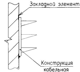
Вариант 2 – заземление оцинкованных кабельных конструкций, закрепляемых с помощью скоб
