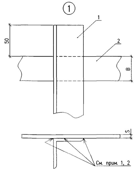
1. Длина сварного шва должна быть не менее  $2B$ . Высота шва определяется толщиной горизонтального заземлителя ( $S$ ).
