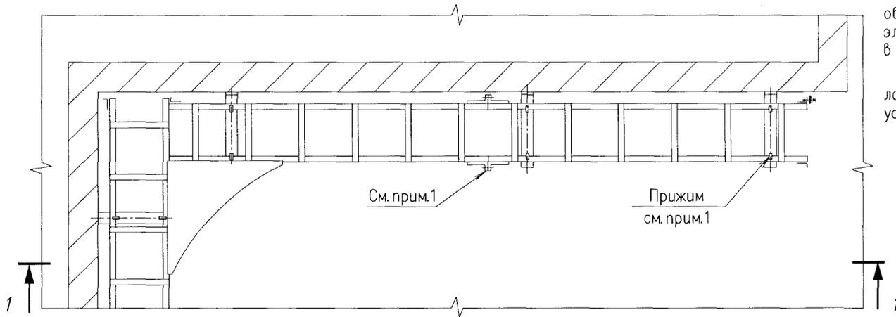
1. Конструкция лотков должна обеспечивать непрерывность электрической цепи в стыках и в местах присоединения к полкам.
