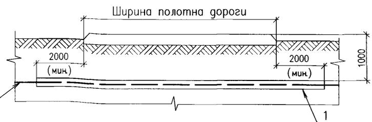
Концы труб должны быть уплотнены джутовыми плетеными шнурами, обмазанными водонепроницаемой глиной на глубину не менее 300мм.
