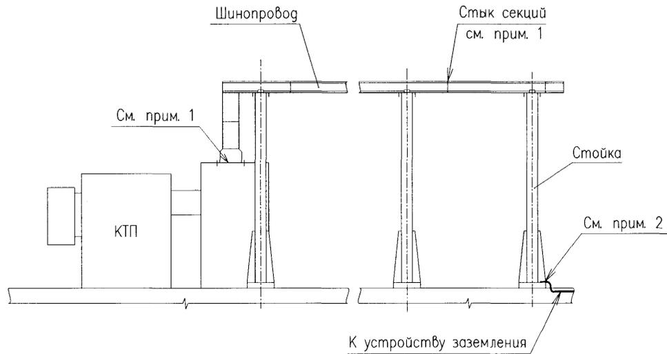
1. Конструкция шинопровода обеспечивает непрерывность электрической цепи в стыках секций, в местах присоединения к стойкам и к шкафу Н.Н.
