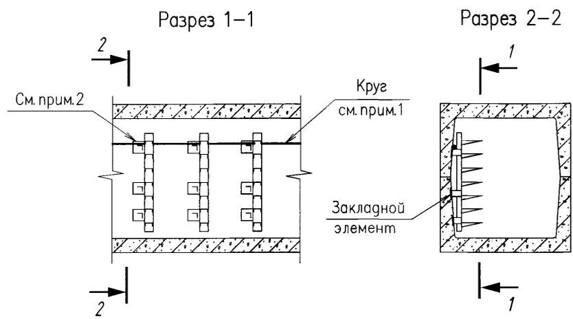
1. Проводник присоединяют в начале и конце трассы к устройству заземления.
