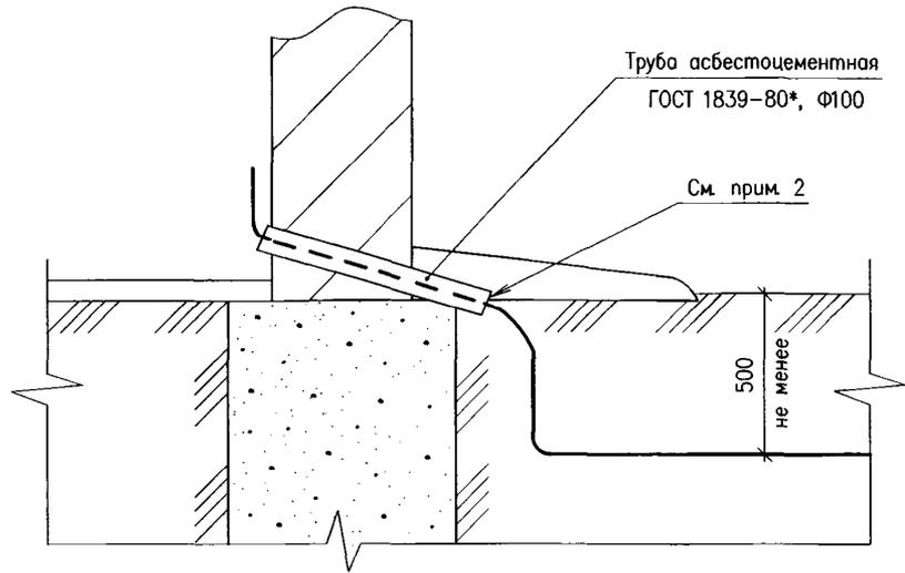
1. Размеры проема должны быть минимальными, обеспечивающими свободный проход проводника.
