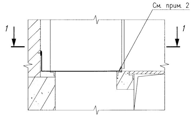
1. Каждую камеру КСО присоединяют не менее, чем в двух местах к обрамлению отверстия, которое используется в качестве заземляющего проводника.
