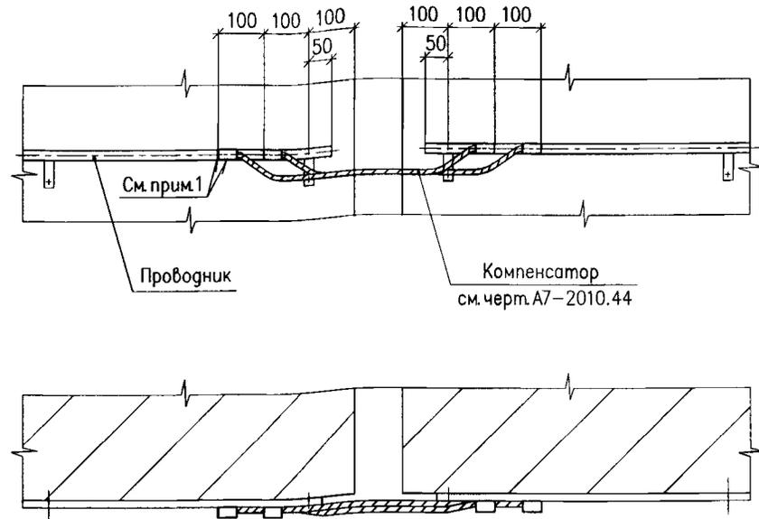
1. Длина сварного шва 30мм, высота – не менее 4мм.
