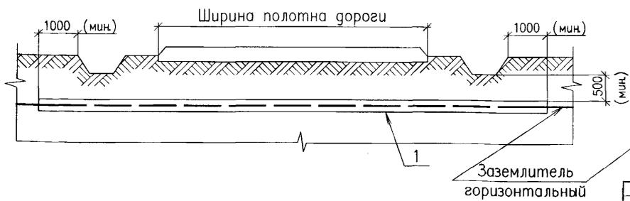
Вариант 4 – без водоотводной канавы
