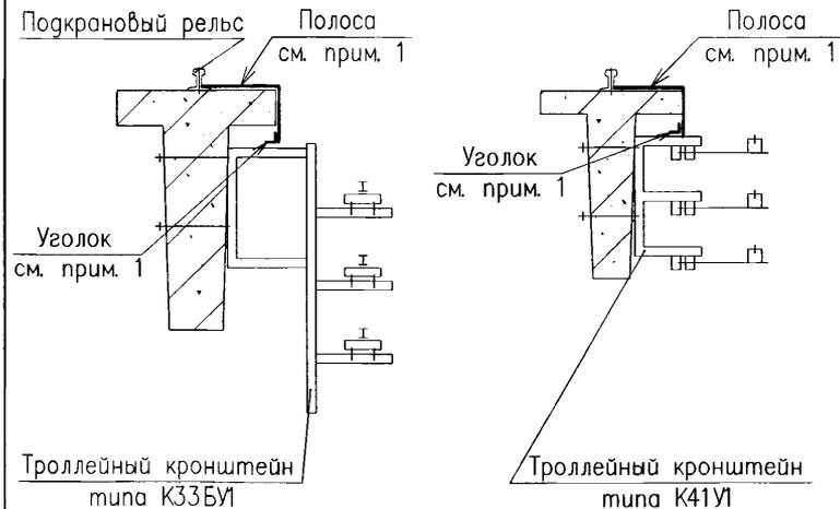
1. Каждый троллейный кронштейн присоединяют сваркой к специально проложенному проводнику (уголку), который должен быть соединен в начале и конце с подкрановым рельсом, используемым в качестве заземляющего защитного проводника.
