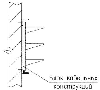
Вариант 2 – заземление блоков оцинкованных кабельных конструкций
