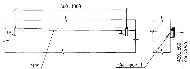
1. Способ крепления держателя определяется при монтаже.
