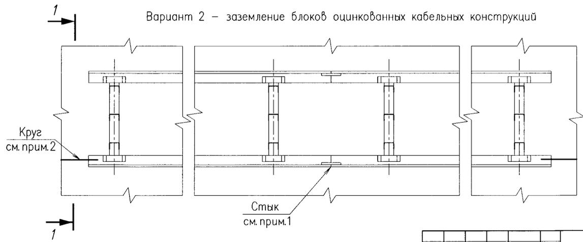
1. Стыки блоков должны быть соединены сваркой для обеспечения непрерывности электрической цепи.
