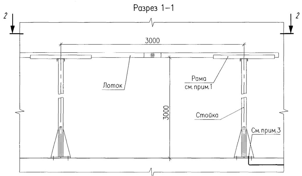
1. Конструкция лотков должна обеспечивать непрерывность электрической цепи в стыках и в местах присоединения при помощи прижимов к рамам стоек.
