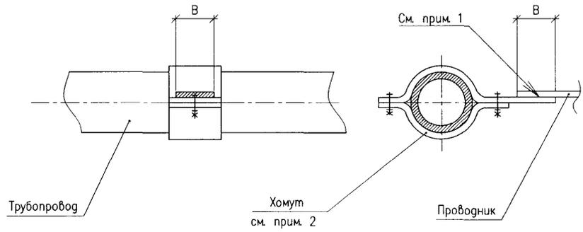
1. Присоединение проводников к трубопроводам должно выполняться сваркой. Длина сварного шва должна быть не менее  $2B$  – для проводников из полосовой стали и  $6d$  – из круглой стали. Высоту сварных швов принимают:
