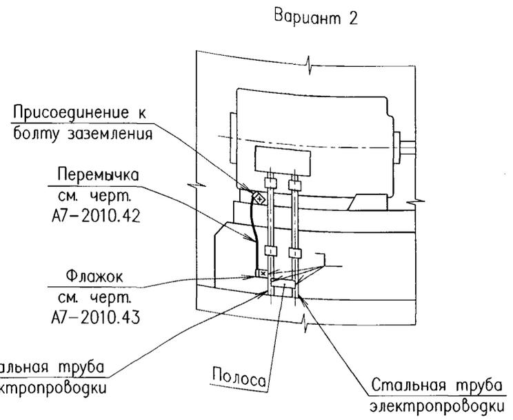
1. На чертеже показаны случаи соединения корпусов двигателей со стальной трубой электропроводки, которая используется в качестве заземляющего защитного проводника.
