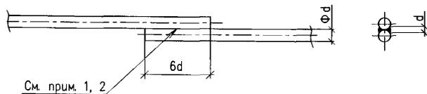
1. Соединение проводников должно выполняться сваркой. Длина сварного шва должна быть не менее  $2B$  – для проводников из полосовой стали и  $6d$  – из круглой стали.
