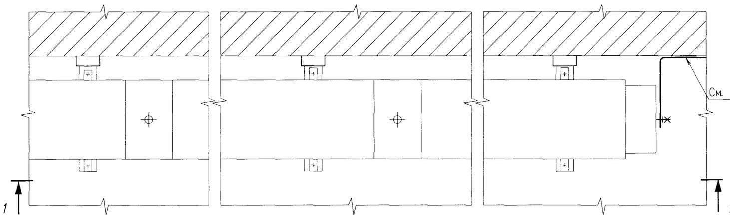
1. Конструкция коробов должна обеспечивать в местах соединения отдельных секций непрерывность электрической цепи.
