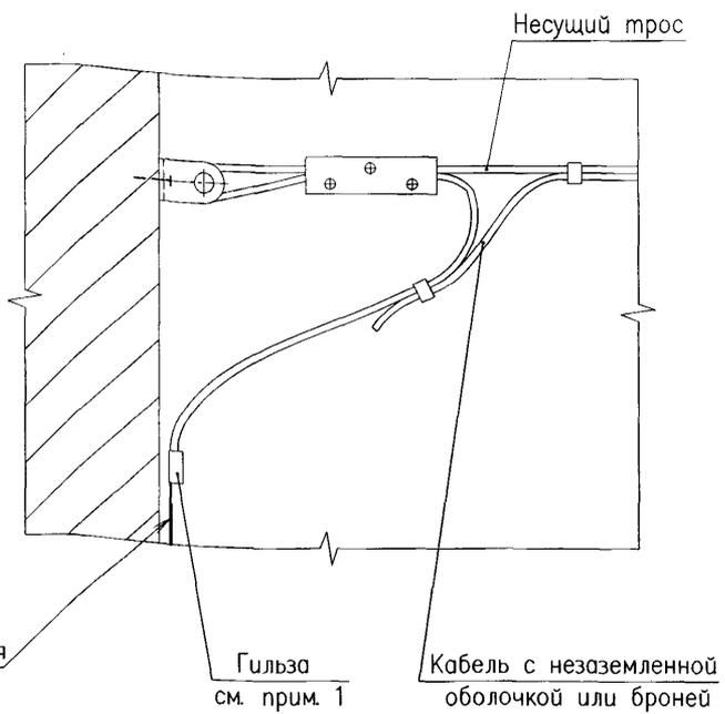
1. Несущий трос присоединяют сваркой с обоих концов к устройству заземления :
