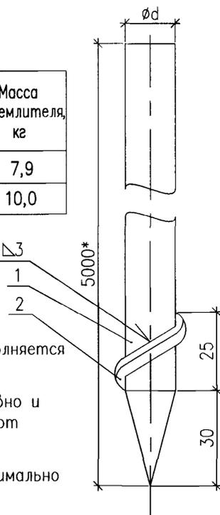
1. Заземлитель по исполнению 1 выполняется из оцинкованной стали.
