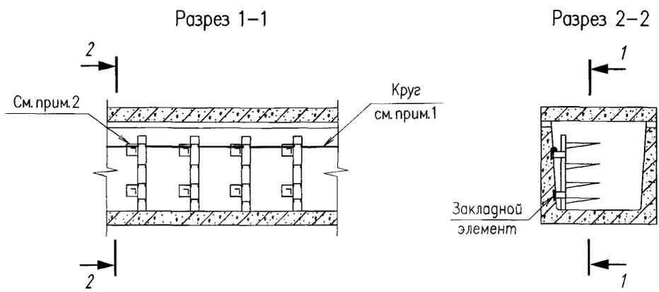
1. Проводник присоединяют в начале и конце трассы к устройству заземления.
