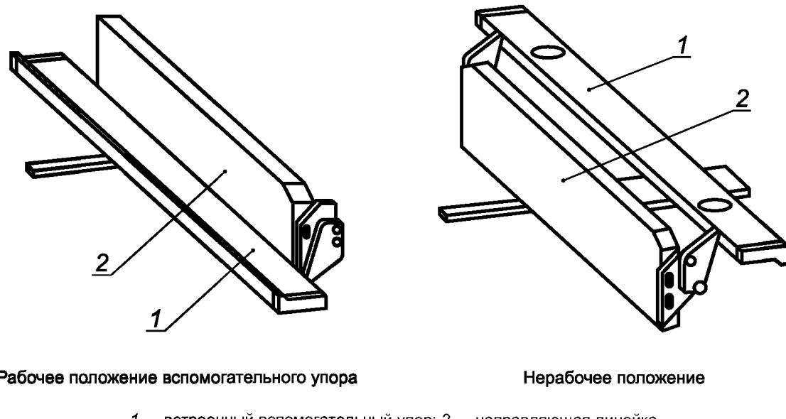
1 — встроенный вспомогательный упор; 2 — направляющая линейка
