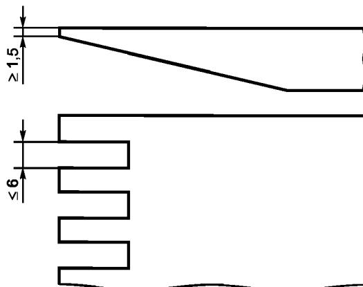
Рисунок 4 — Пример — кромки стола с пазами
