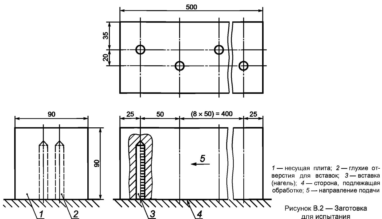
Рисунок В.2 — Заготовка для испытания
