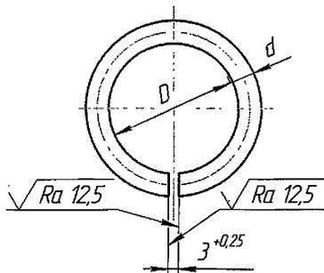
Рисунок 8 – Конструкция соединительного кольца, тип I
