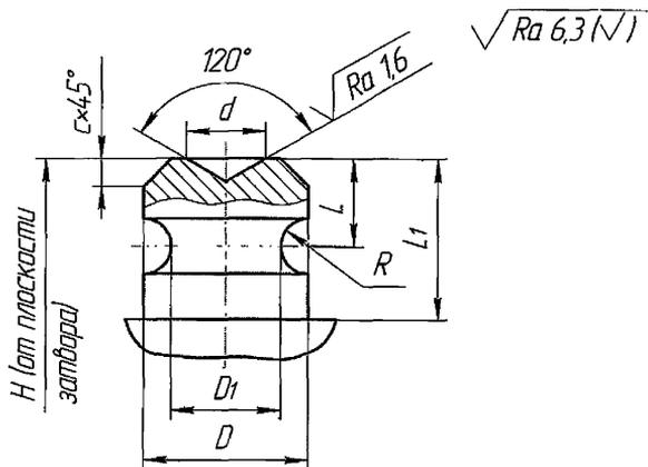
Рисунок 3 – Конструкция соединительной части диска, тип I
