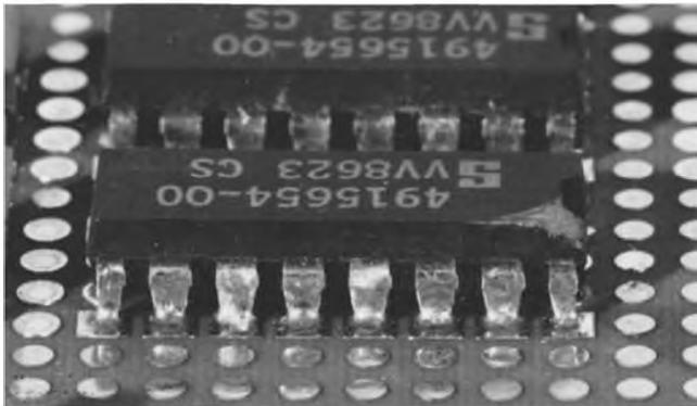
Рисунок 53 — DIP-корпус: допустимое состояние
