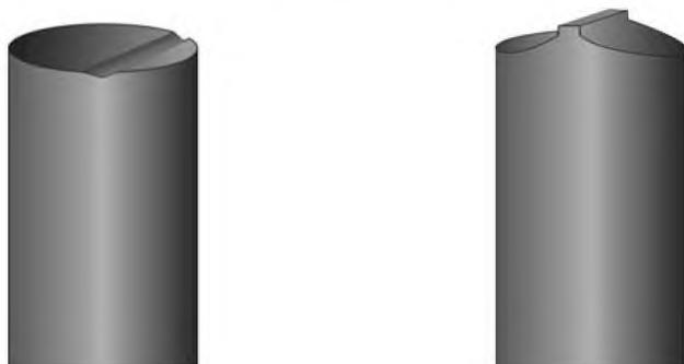
Рисунок 8 — Обрезка вывода: заданное состояние
