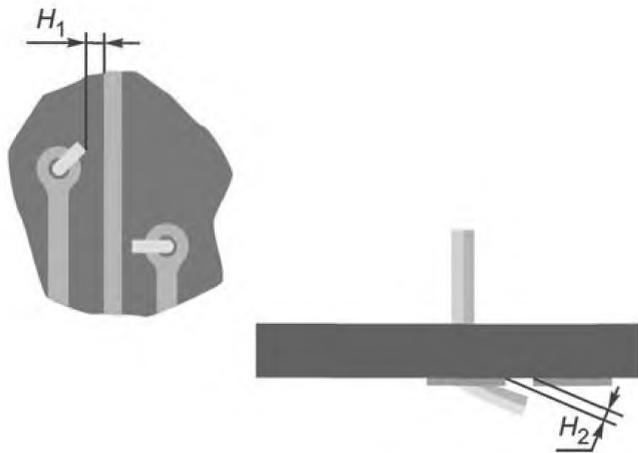
Рисунок 6 — Частично загнутый вывод: допустимое состояние
