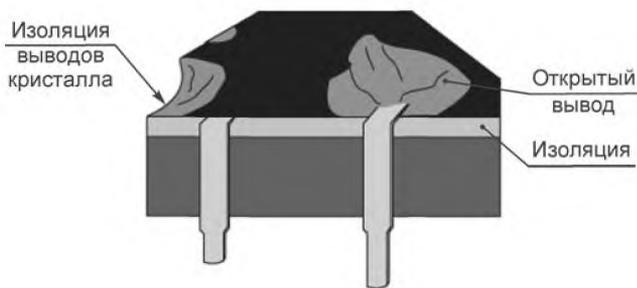
Рисунок 54 — DIP-корпус: недопустимое состояние
