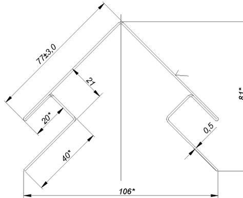
**Рисунок Б.1 – Угол наружный (УСНс)**
