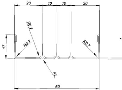
Рисунок В.5 – Профиль направляющий П-образный 60x17 (НПП 60x17)
