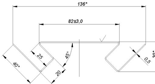
**Рисунок Б.2 – Угол внутренний (УСВс)**
