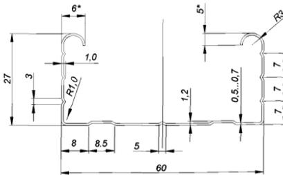
Рисунок В.6 – Профиль направляющий П-образный 60x27 (НПП 60x27)
