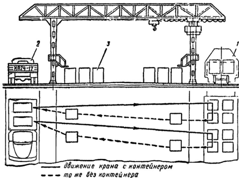
Рис. 4. Схема работы козлового крана:
