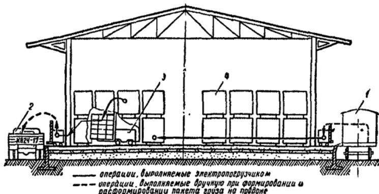
Рис. 2. Схема работы погрузчика и бригады:
