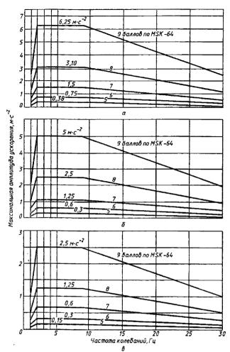
а – при высоте установки оборудования над нулевой отметкой 70-30 м;
