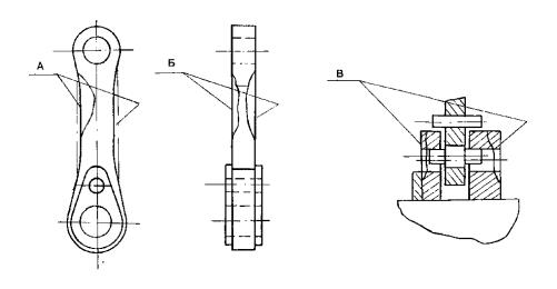
А– поверхность приварки уравновешивающей массы фрезерования при подгонке массы билодержателя;
