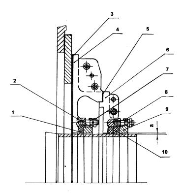
1— набивка АМБ 25Х25; 2— кольцо уплотнительное; 3— прокладка; 4— корпус уплотнения; 5— прокладка; 6— крышка; 7— шпилька; 8— шпилька; 9— кольцо уплотнительное; 10— набивка.
