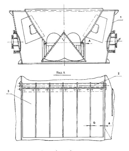
1- конус; 2- петля; 3- заслонка. Рисунок 6 - Средняя часть центробежного сепаратора
