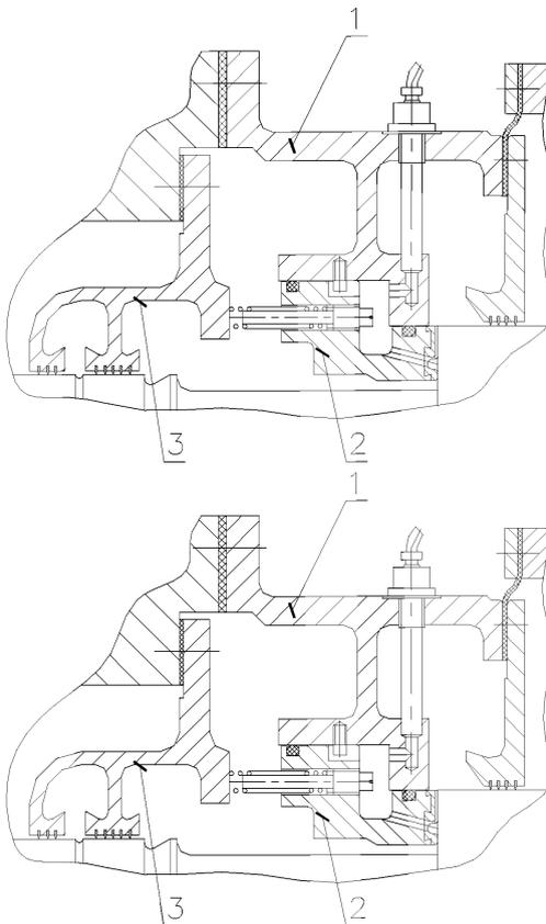
1 – корпус уплотнения; 2 – вкладыш уплотнения; 3 – маслоуловитель.
