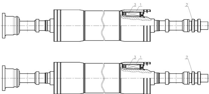
1 – бандажный узел; 2 – контактные кольца с токоподводом; 3 – обмотка ротора.
