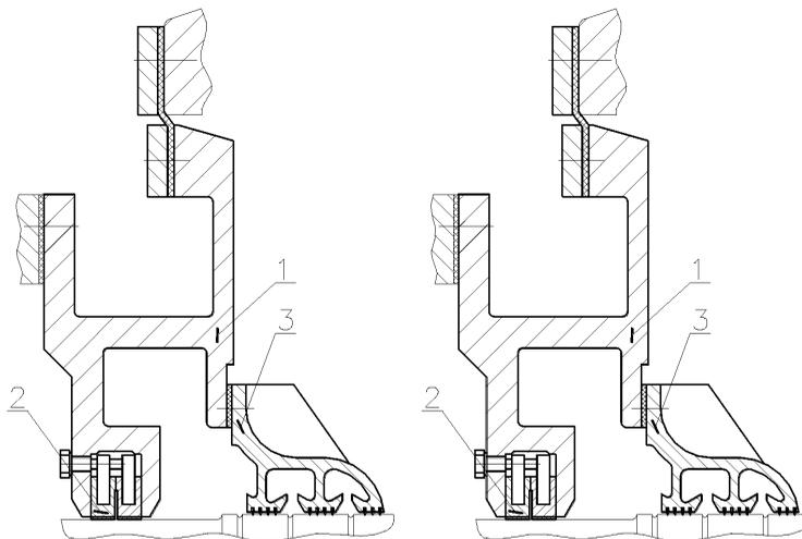
1 – корпус уплотнения; 2 – вкладыш уплотнения; 3 – маслоуловитель.
