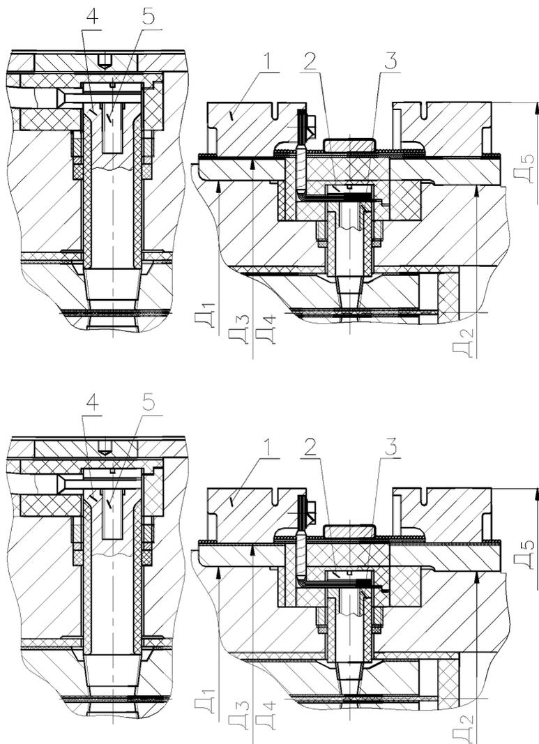
1 – контактное кольцо; 3, 4 – токоведущий болт; 2,5 – контактный винт.
