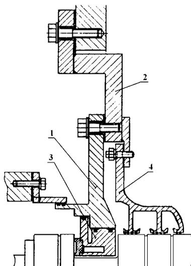
1 – корпус уплотнения; 2 – щит наружный; 3 – вкладыш уплотнения;
