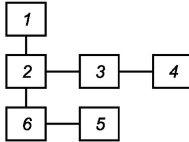
1 — источник постоянного напряжения; 2 — формирователь импульсов; 3 — коаксиальный измерительный электрический соединитель из комплекта поверяемого вольтметра; 4 — коаксиальная согласованная нагрузка; 5 — поверяемый вольтметр; 6 — цифровой вольтметр постоянного тока
