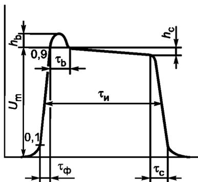
$U_m$  — амплитуда импульса;  $h_b$  — амплитуда выброса;  $h_c$  — глубина спада вершины импульса; 0,1 и 0,9 — уровни отсчета фронта импульса;  $\tau_\phi$  — время нарастания фронта импульса;  $\tau_b$  — длительность выброса;  $\tau_i$  — длительность импульса;  $\tau_c$  — время спада импульса
