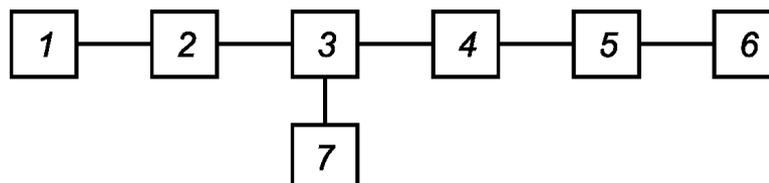
1 — генератор импульсов; 2 — согласующее устройство; 3 — коаксиальный измерительный электрический соединитель из комплекта эталонного вольтметра; 4 — эталонный делитель напряжения; 5 — коаксиальный измерительный электрический соединитель из комплекта поверяемого вольтметра; 6 — поверяемый вольтметр; 7 — эталонный вольтметр
