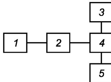
1 — генератор импульсов; 2 — нагрузка генератора импульсов; 3 — эталонный вольтметр; 4 — коаксиальный измерительный электрический соединитель из комплекта эталонного вольтметра; 5 — поверяемый вольтметр
