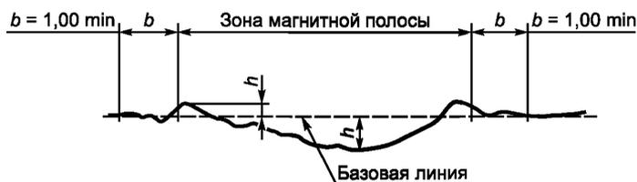
Рисунок 8 — Вогнутый профиль полосы
