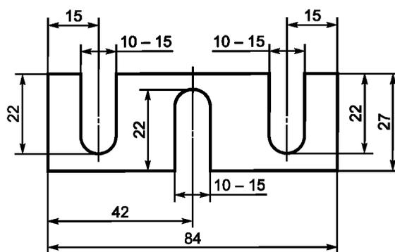
Рисунок 4 — Пластина — держатель карты (контактная поверхность)
