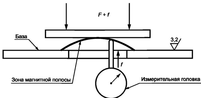
Рисунок 1 — Схема измерительной установки
