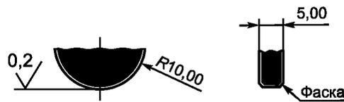
Рисунок 10 — Размеры контактной поверхности имитатора головки
