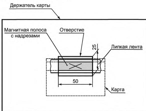
Рисунок 18 — Схема испытания магнитной полосы на адгезию
