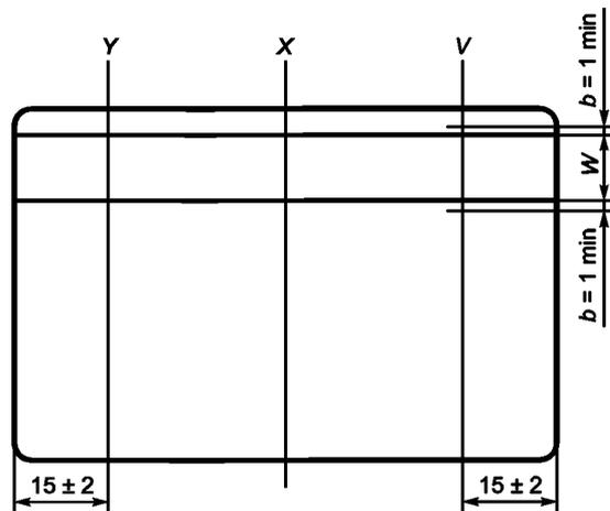
Рисунок 5 — Положение линий измерений профиля магнитной полосы
