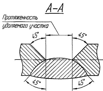
а - дефектный участок сварного шва; б - односторонняя вырубка;
