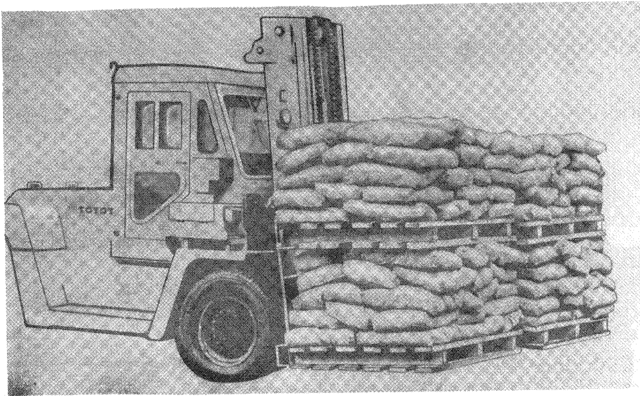
Рис. I06. I6. Внутрипортовое транспортирование одновременно 4-х пакетов цемента на поддонах. Порт Николаев.
