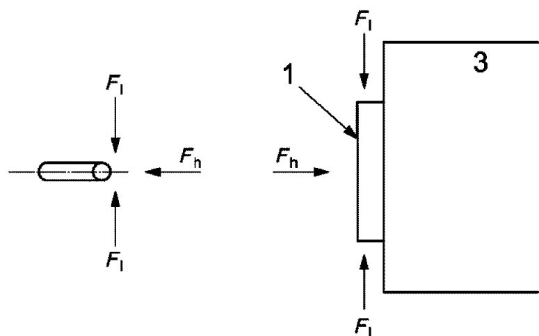
Рис. 1 Схема расположения "направляющие — привальные брусья (бамперы)":
