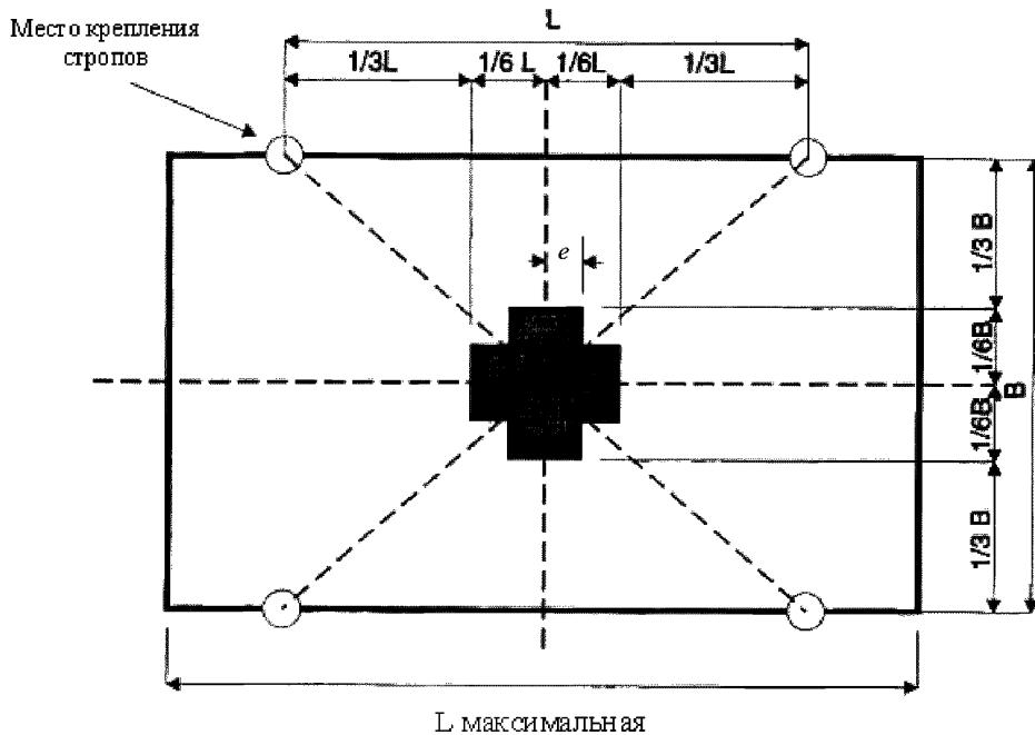
Рис. 3.3.4 Допускаемое положение ЦТ
