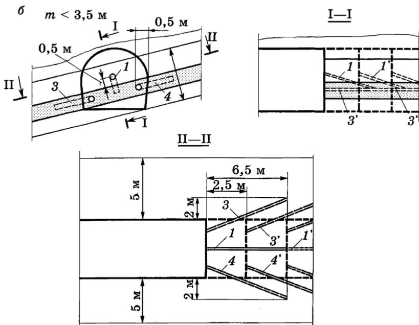
контрольных шпуров (3, 4) при низконапорной пропитке
