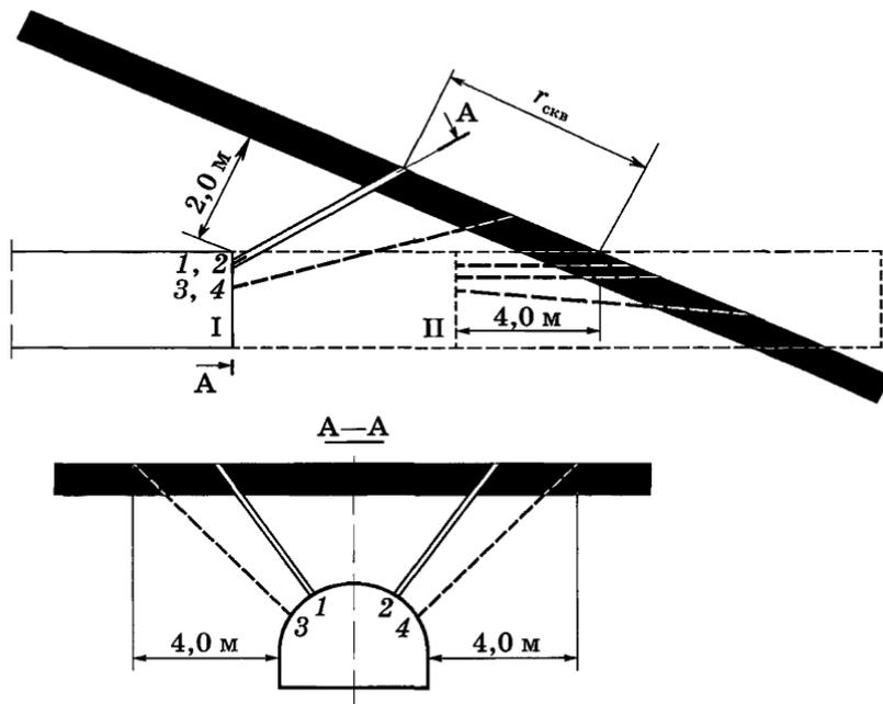
**Рис. 4.7.** Схема расположения скважин для гидрообработки угольного массива перед вскрытием пологих, наклонных и крутонаклонных пластов: 1, 2 — скважины для гидрорыхления массива; 3, 4 — шпурсы для замера давления газа;  $r_{\text{скв}}$  — радиус эффективного влияния скважины; I, II — циклы обработки пласта
