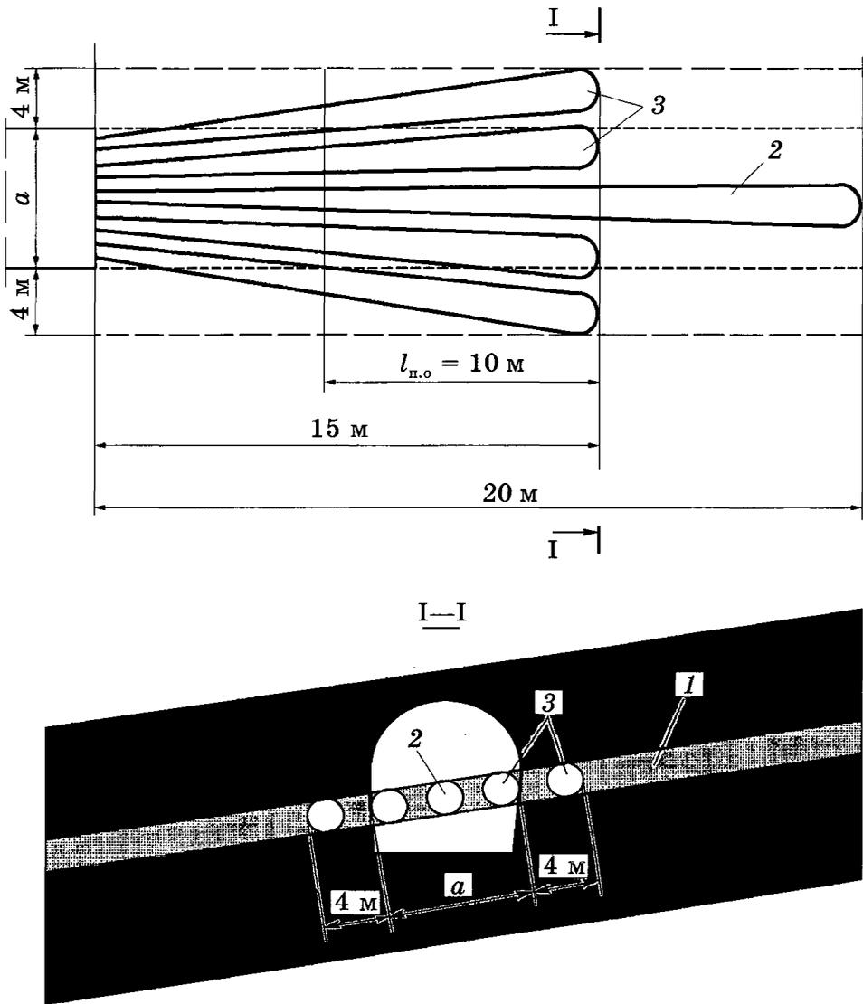
Рис. 5.5. Схема гидровымывания опережающих полостей:
