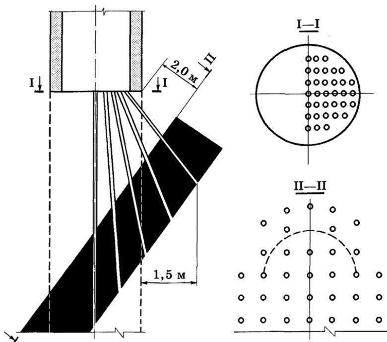
**Рис. 4.2.** Схема расположения дренажных скважин при обнажении крутых пластов
