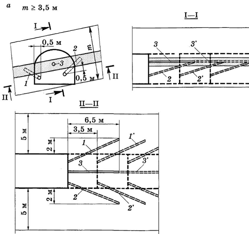
Рис. 5.3. Схема бурения скважин для пропитки (1, 2) и
