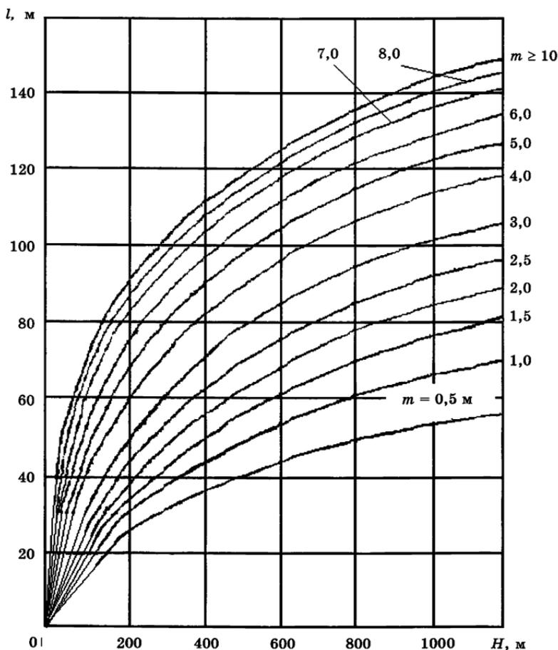
Рис. 3.2. Номограмма для определения ширины зоны опорного давления
