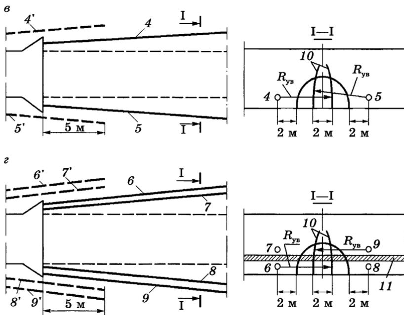
одинокую скважину 1; б — через парные передовые скважины 2, 3; скважины 6, 7 и 8, 9; 10 — граница увлажнения; 11 — водонепроницаемый скважины предыдущего цикла увлажнения
