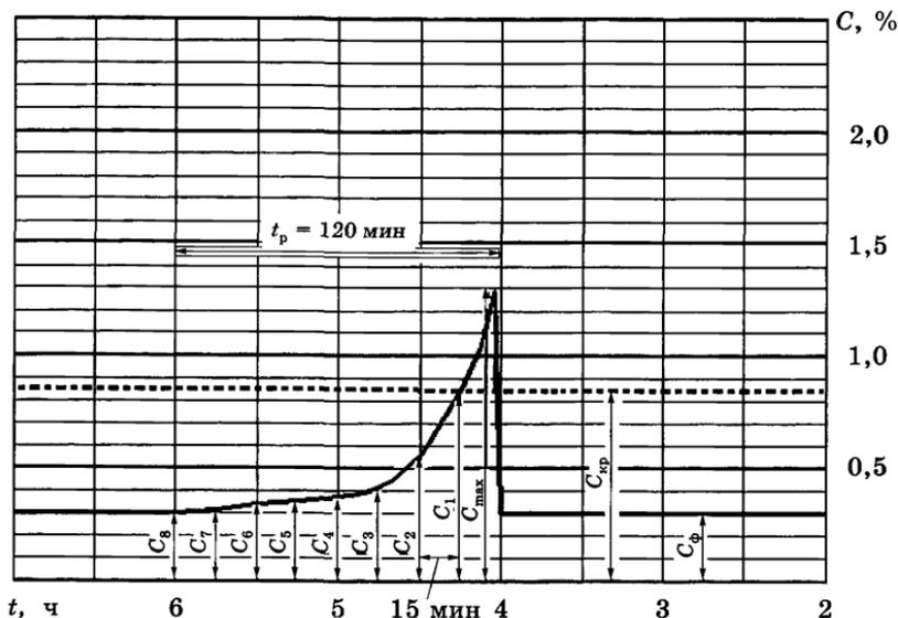
Рис. 2.2. Обработка диаграммы АКМ после взрывных работ для определения выбороопасности забоя
