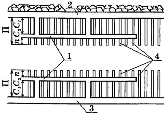
Рис. 3. Схема приведения в неудароопасное состояние выработок, оконтуривающих целики: 1 — проводимая выработка; 2, 3 — вентиляционный и откаточный штреки; 4 — скважины большого диаметра
