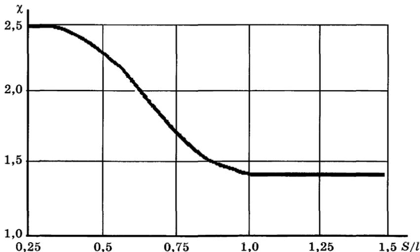
**Рис. 10.3.** Номограмма для определения коэффициента пригрузки  $\chi$ :
