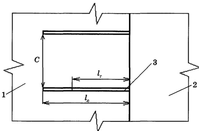
**Рис. 9.5.** Схема расположения шпуров для гидростатического теста пласта:
