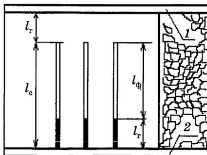
Рис. 9.3. Схема глубинного увлажнения угольного пласта впереди очистного забоя:
