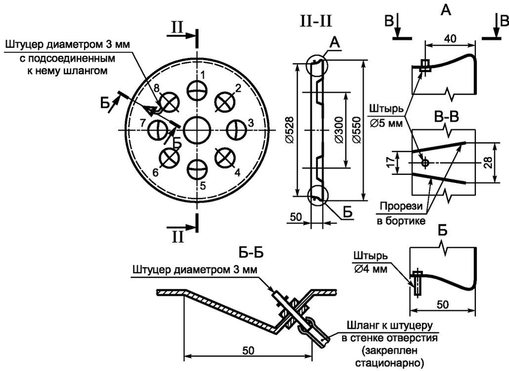
Рисунок 4 — Пластина с отверстиями к кожуху вентилятора
