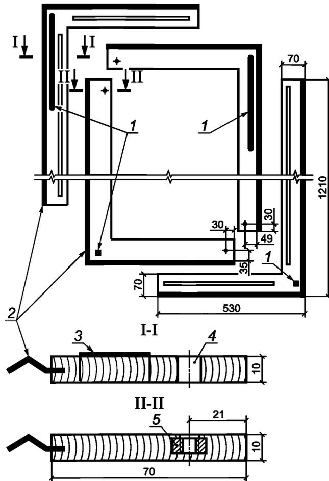
1 — липучие элементы; 2 — уплотнительный профиль из пористой резины; 3 — липучая полоса;
