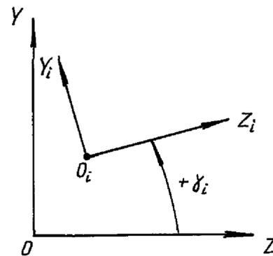
$OXYZ$  - базовая система координат модели;
