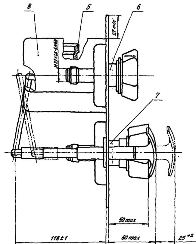
1 - панель; 2 - крышка штуцера контроля по ОСТ 1 10795-72; 3 - крышка штуцера слива по ОСТ 1 10795-72; 4 - крышка штуцера заправки по ОСТ 1 14375-85; 5 - клапан запорный водяной; 6 - штуцер контроля; 7 - штуцер заправки; 8 - электронагреватель
