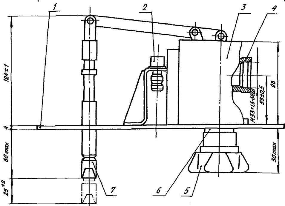
1 - панель; 2 - электрический соединитель; 3 - электроннагреватель; 4 - клапан запорный водной по OCT 1 03896-78; 5 - крышка штуцера слива по OCT 1 14375-85; 6 - штуцер слива; 7 - рукоятка; 8 - этикетка с информацией
