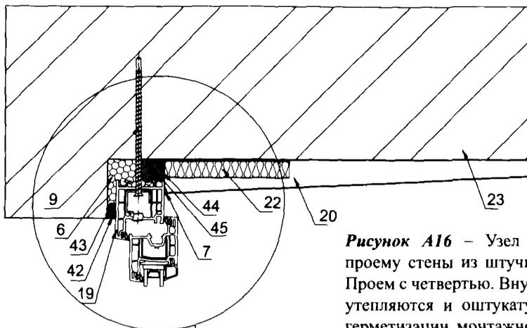
**Рисунок А16** – Узел примыкания к проему стены из штучного материала. Проем с четвертью. Внутренние откосы утепляются и оштукатуриваются. Для герметизации монтажного шва применены мастичные герметики.
