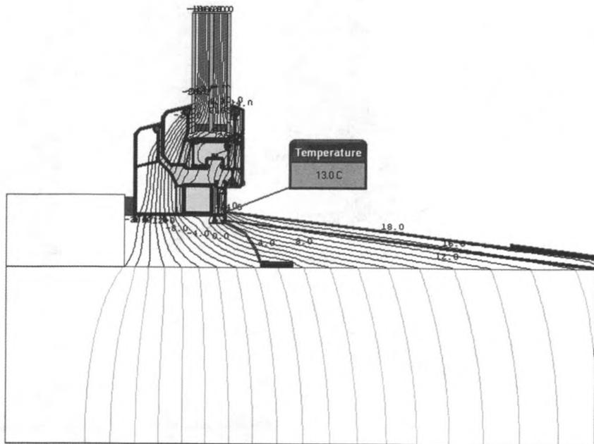
**Рисунок К.10** – Температурное поле узла примыкания светопрозрачной конструкции из ПВХ профиля XXXXXXXXXXXXXXXXXX. Сечение узла примыкания вертикального бруска оконной коробки к ограждающей конструкции с четвертью. Откос выполнен ПВХ панелью толщиной 10 мм. С утеплением внутреннего откоса. Температура на участке примыкания подоконника к коробке рамы 13,0 °С.
