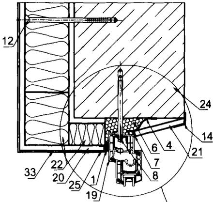
**Рисунок А5** – Узел примыкания СПК к стене из железобетона и эффективного утеплителя со стороны улицы. Утеплитель в проеме образует четверть. СПК смещается на середину толщины несущей части стены. Внутренние откосы отделяются плитными материалами. Необходим теплотехнический расчет данного узла.
