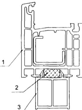
**Рисунок 3** – Уплотнение места примыкания подставочного профиля к профилю коробки СПК с применением ПСУЛ
