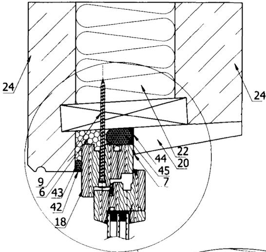
**Рисунок А18** – Узел примыкания СПК к проему трехслойной железобетонной панели с эффективным утеплителем в качестве среднего слоя. Проем с четвертью. Внутренние откосы оштукатуриваются. Для герметизации монтажного шва применены мастичные герметики.
