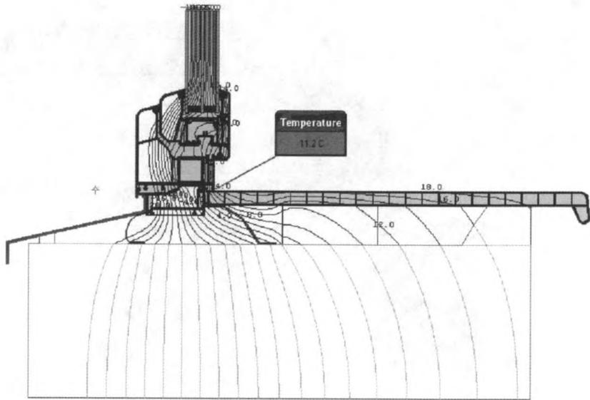
**Рисунок К.6** – Температурное поле узла примыкания светопрозрачной конструкции из ПВХ профиля XXXXXXXXXXXXXXXXXX. Сечение узла в нижней части в зоне неполного заполнения зазора под подоконником утеплителем. Температура на участке примыкания подоконника к коробке рамы 11,2 °С.
