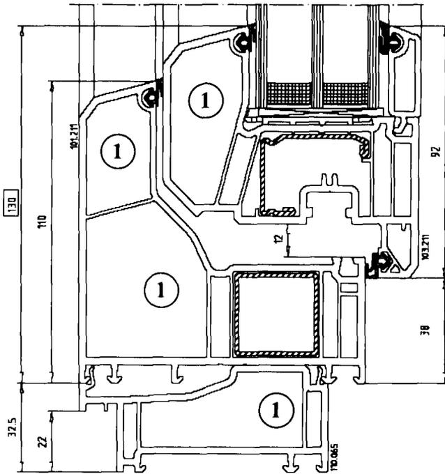
**Рисунок К.2** – Конструкция коробка + створка + подставочный профиль светопрозрачной ограждающей конструкции XXXXXXXXXXXXXXXXXX (нижний узел примыкания). Пустоты I заполнены экструдированным полистиролом.
