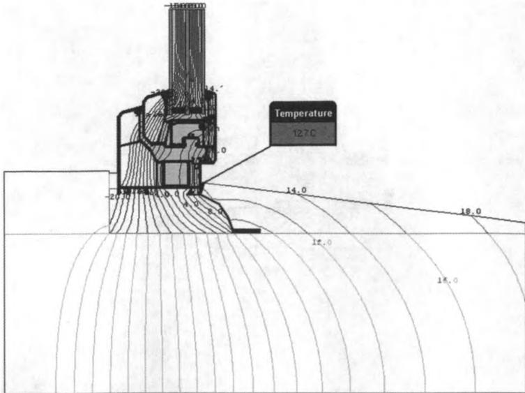
**Рисунок К.7** – Температурное поле узла примыкания светопрозрачной конструкции из ПВХ профиля ~~XXXXXXXXXXXXXXXXXX~~. Сечение узла примыкания вертикального бруска оконной коробки к ограждающей конструкции с четвертью. Откос выполнен цементно-песчаным раствором с последующей окраской. Температура на участке примыкания подоконника к коробке рамы 12,7 °С.
