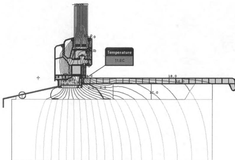
**Рисунок К.4** – Температурное поле узла примыкания светопрозрачной конструкции из ПВХ профиля XXXXXXXXXX. Сечение узла в нижней части в зоне расположения опорной колодки ПВХ подоконника. Температура на участке примыкания подоконника к коробке рамы 11,8 °С.
