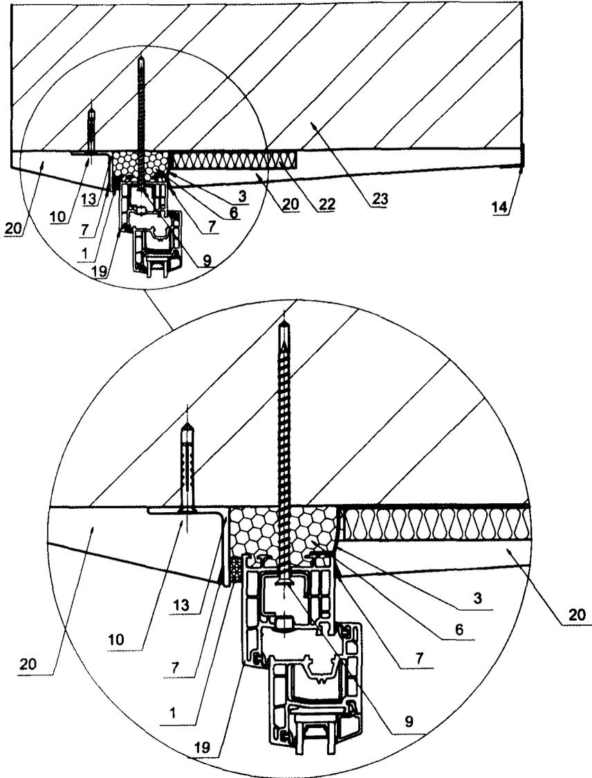
**Рисунок А1** – Узел примыкания к проему стены из штучного материала. Проем без четверти. Организация фальшчетверти с применением металлического или пластмассового уголка. Внешние откосы оштукатуриваются. Внутренние откосы утепляются и оштукатуриваются.
