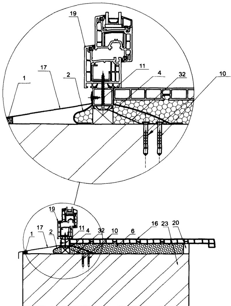
**Рисунок А4** – Нижний узел примыкания СПК к проему из штучного материала. Крепление СПК на гибкие анкерные пластины устраняет риск протечки через крепежные отверстия. Лента Робибанд НЛ применена по схеме «внакладку».
