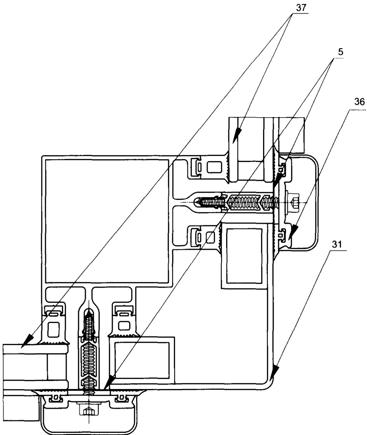
*Рисунок А13* – Герметизация примыкания прижимной планки в СПК из алюминиевых профилей.
