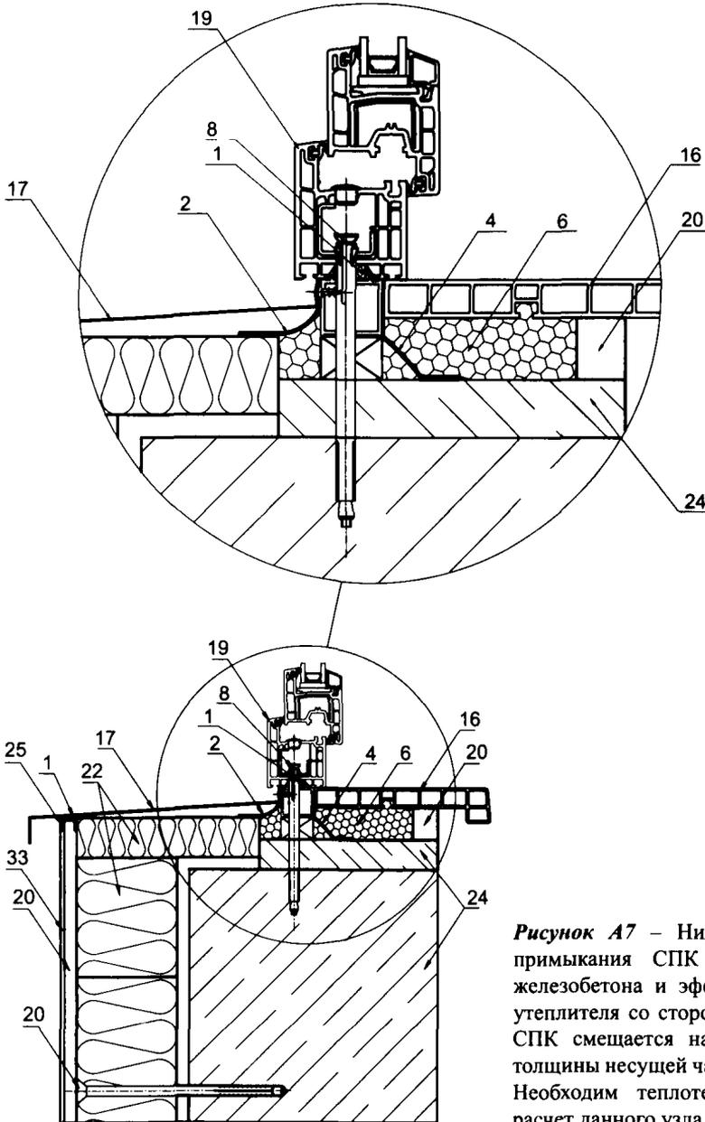
**Рисунок А7** – Нижний узел примыкания СПК к стене из железобетона и эффективного утеплителя со стороны улицы. СПК смещается на середину толщины несущей части стены. Необходим теплотехнический расчет данного узла.
