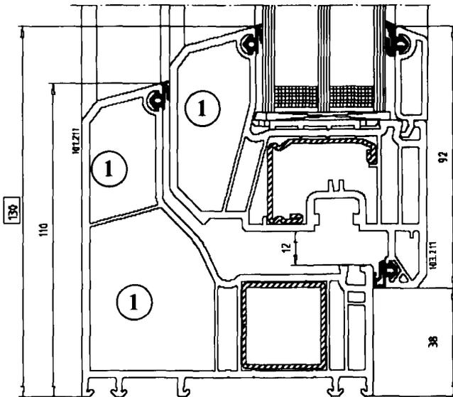
Рисунок К.1 – Конструкция коробка + створка светопрозрачной ограждающей конструкции XXXXXXXXXXXXXXXXXX (боковые и верхнее примыкания).
