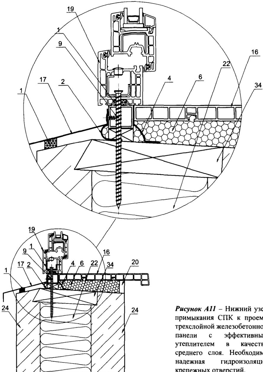
**Рисунок А11** – Нижний узел примыкания СПК к проему трехслойной железобетонной панели с эффективным утеплителем в качестве среднего слоя. Необходима надежная гидроизоляция крепежных отверстий.
