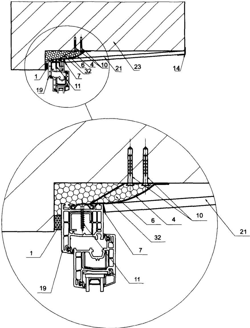
**Рисунок А3** – Узел примыкания к проему стены из штучного материала. Проем с четвертью. Внутренние откосы отделываются плитными материалами.
