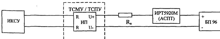
Термопреобразователи с унифицированным выходным сигналом (0...5) мА
