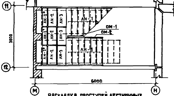
РАСКЛАДКА ПРОСТУПЕЙ ЛЕСТНИЧНЫХ МАРШЕЙ, ПРОМЕЖУТОЧНОЙ И ВЕРХНЕЙ ПЛОЩАДОК
