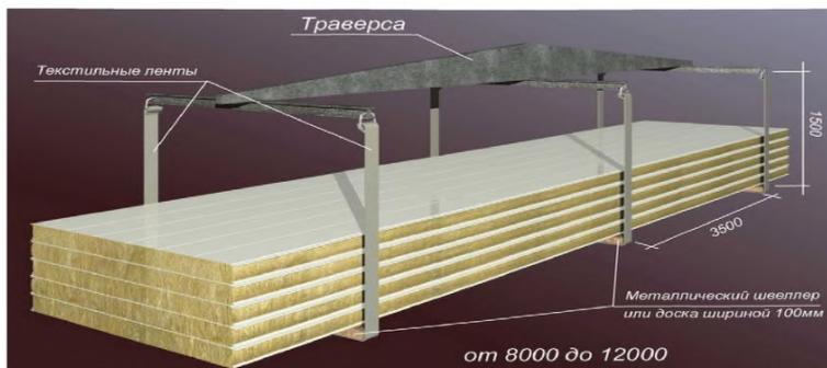
Рисунок 10 – Схема строповки пакетов панелей длиной более 8000 мм
