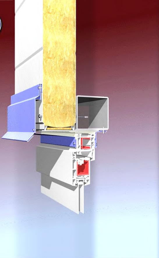
металлический дверной косяк приваривается к пластине поз 2. Деревянный или ПВХ прикрепляется к пластине самонарезающими винтами из комплекта поставки поставщика дверных блоков.
