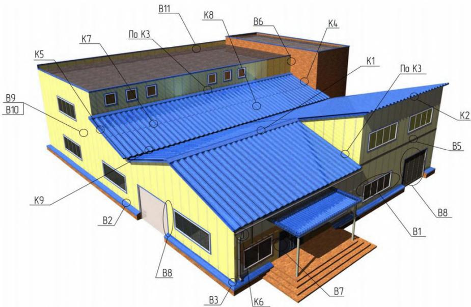
**Рисунок 1а – Здание с вертикальной раскладкой стеновых панелей.**
