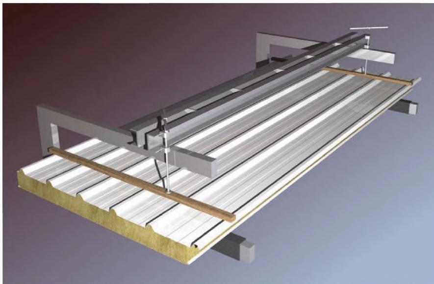
Рисунок 12г – Траверса для перемещения кровельных панелей
