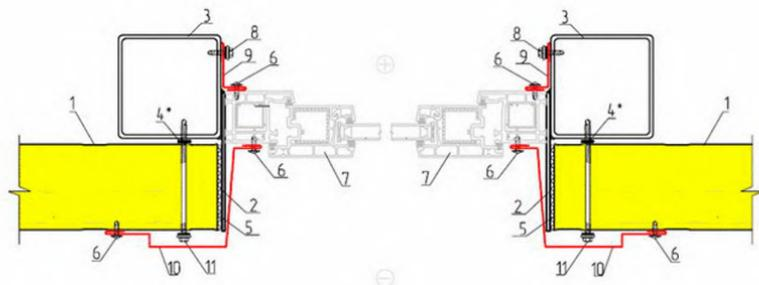
металлический дверной косяк прибивается к пластине поз.2.
