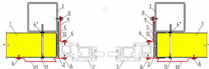
металлический дверной косяк приваривается к пластине поз.2.
