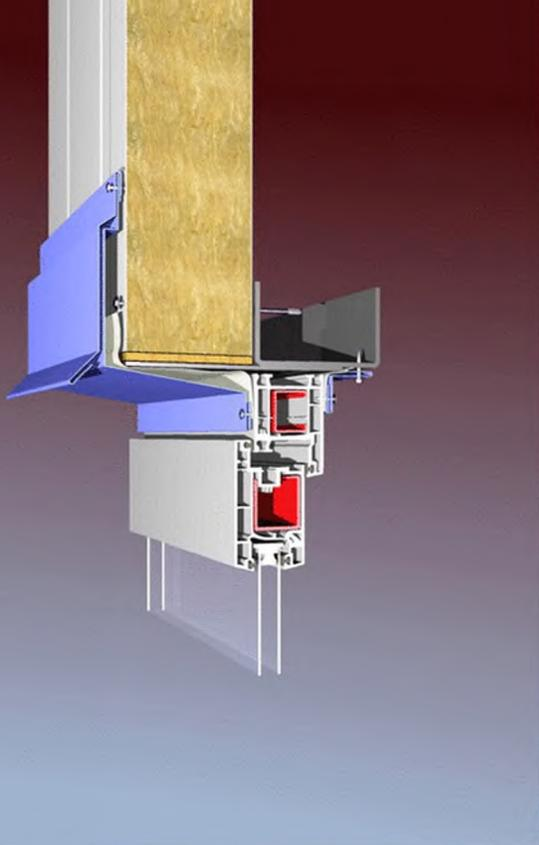
металлический дверной косяк приваривается к пластине поз.2. Деревянный или ПВХ прикрепляется к пластине самонарезающими винтами из комплекта поставки поставщика дверных блоков.
