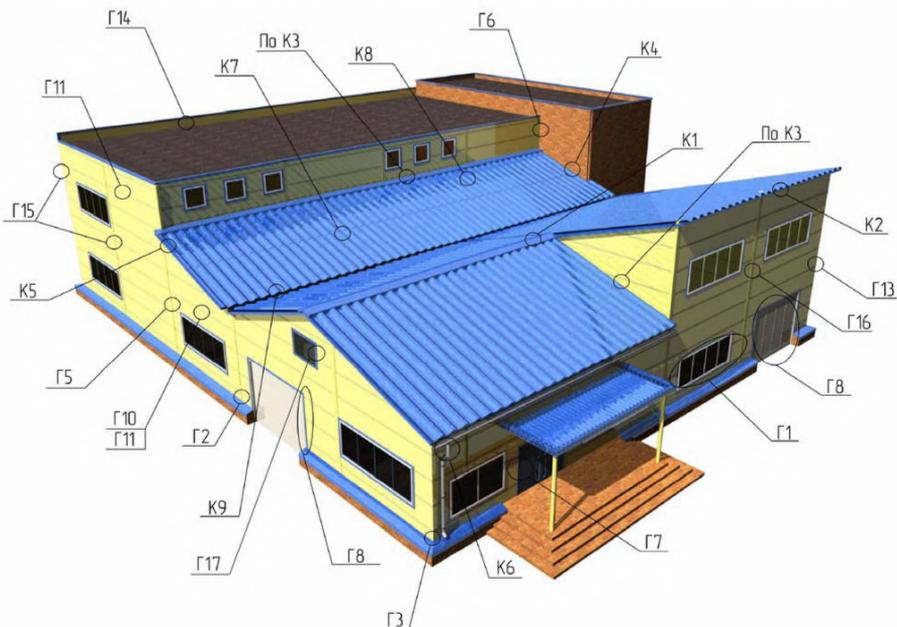
**Рисунок 1б – Здание с горизонтальной раскладкой стеновых панелей.**
