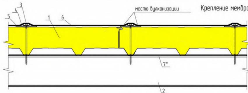
Крепление мембраны с помощью системы KLEMMFIX
