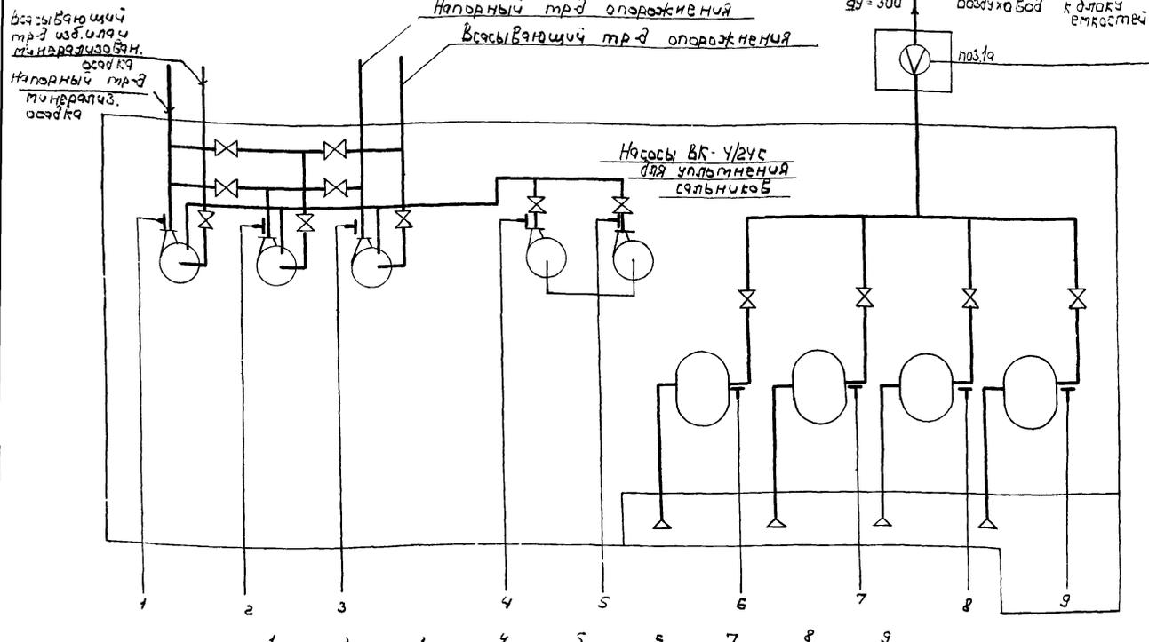
Схема внешних трубных и кабельных соединений
