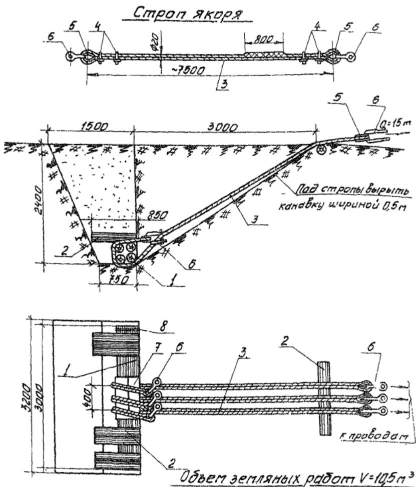
Рис.2. Земляной якорь для временного крепления трех проводов
