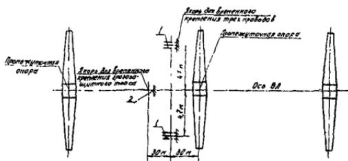
Рис.1 План расположения якорей для временного крепления проводов и грозозащитного троса
