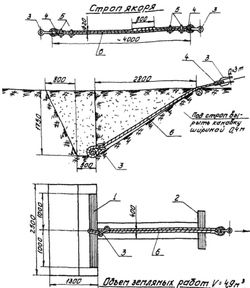
Рис.4 Земляной якорь для временного крепления грозозащитного троса
