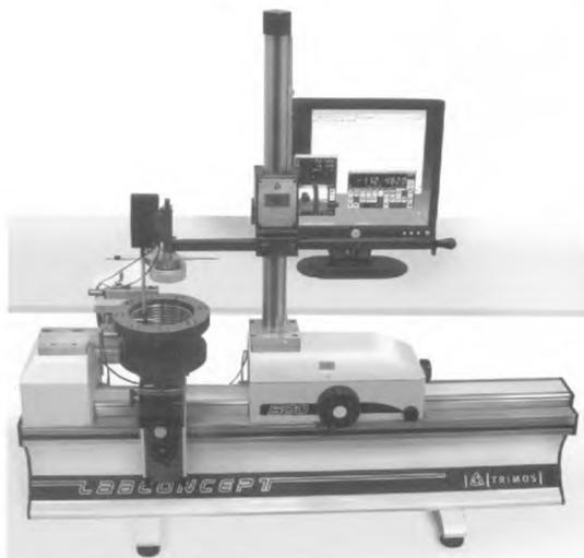
Рисунок Д.1 — Горизонтальный длиномер LabConcept 500
