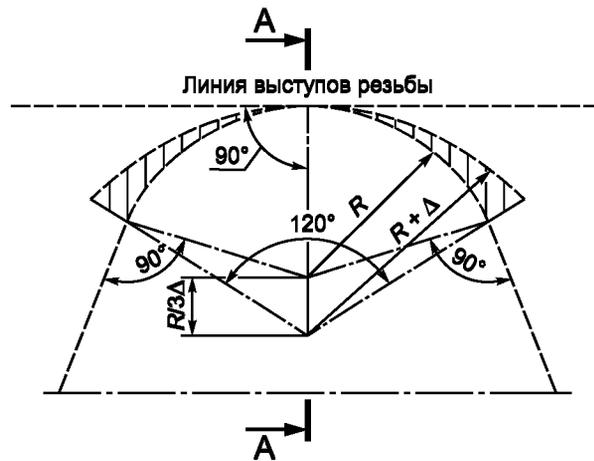
Рисунок А.1 — Шаблон для проверки профиля резьбы
