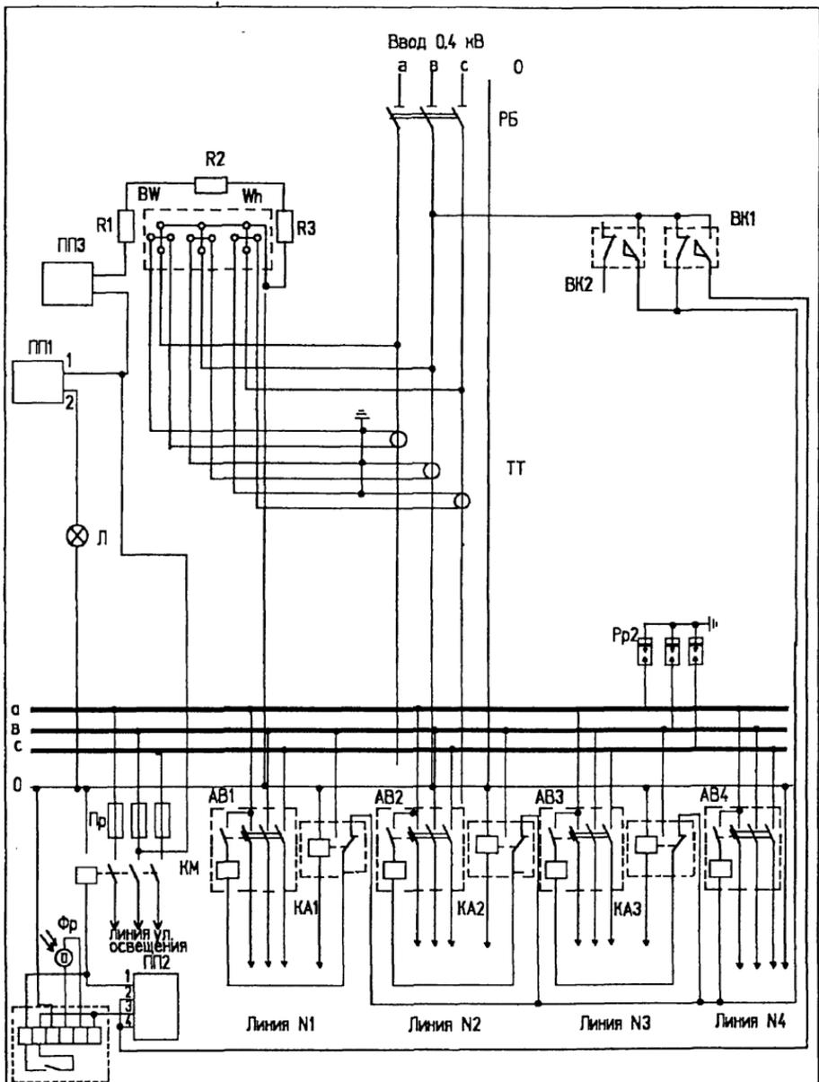
Схема электрическая РУ 0,4 кВ КТП 250 кВА
