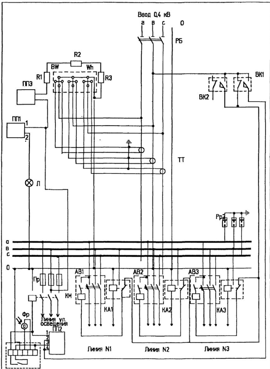
Схема электрическая РУ 0,4 кВ КТП 25-160 кВА
