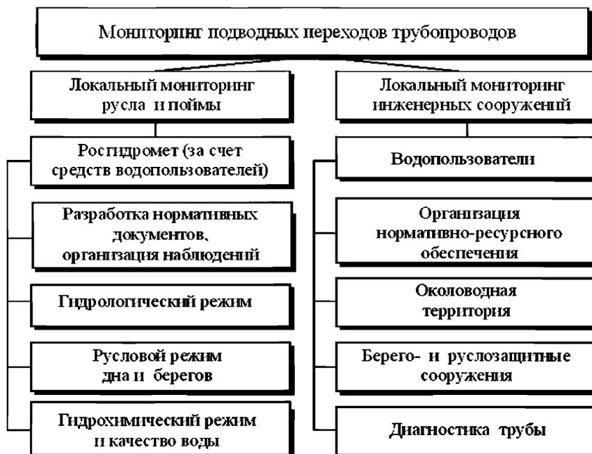
Рисунок 14.1 — Структура мониторинга подводных переходов трубопроводов
