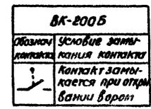
Диаграмма замыкания контактов датчика температуры "BK"
