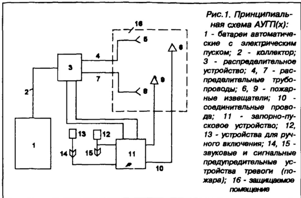
распределительные устройства на 2 направления типа РУ-25А (или РУ-32А, РУ-50А, РУ-70А);
