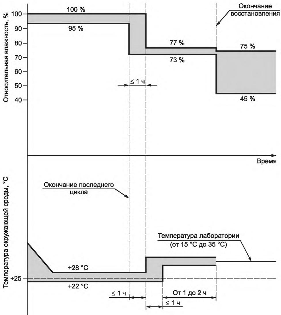
Рисунок 3 — Испытание Db. Восстановление в регулируемых условиях
