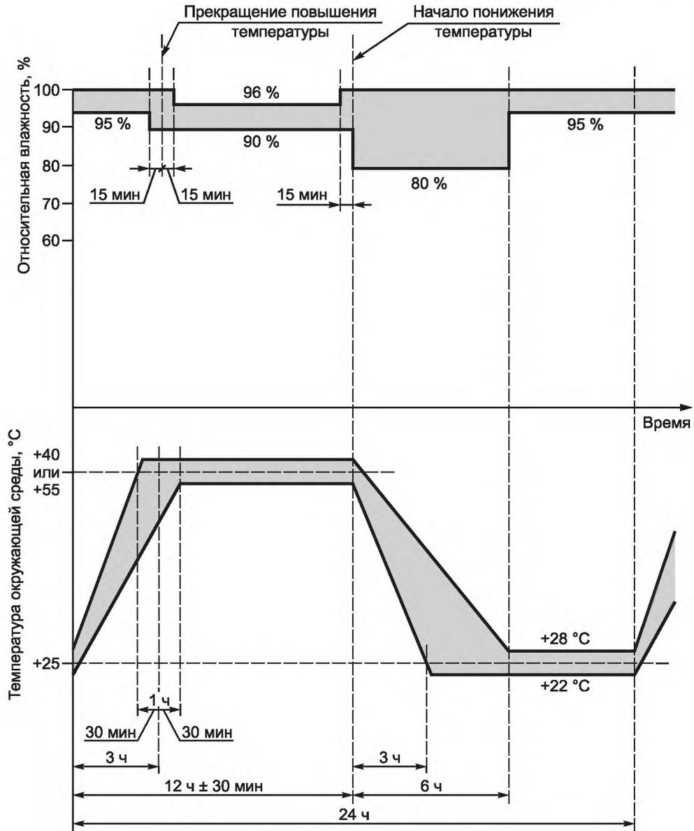
Рисунок 2b — Испытание Db. Цикл испытания. Вариант 2
