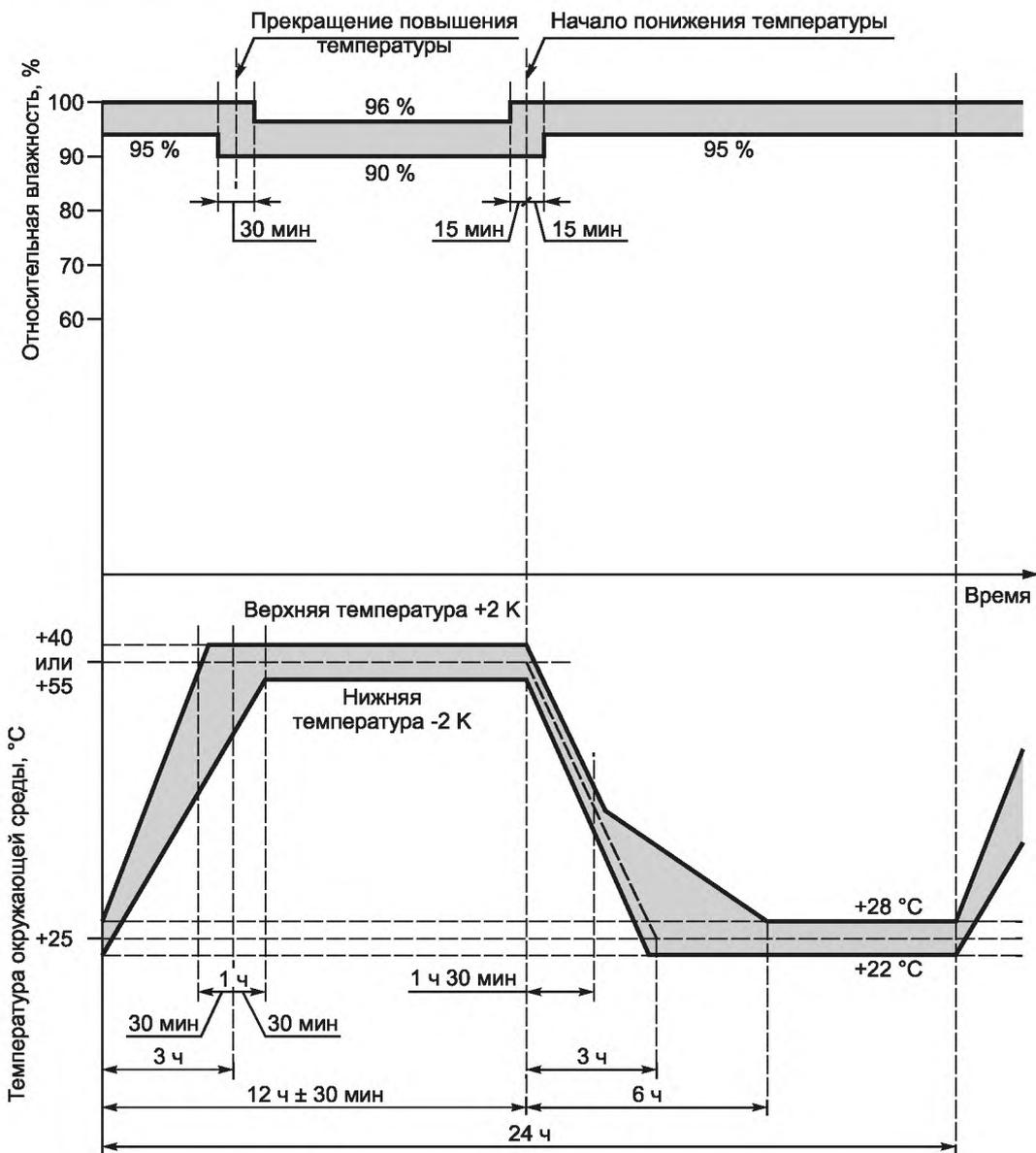
Рисунок 2а — Испытание Db. Цикл испытания. Вариант 1
